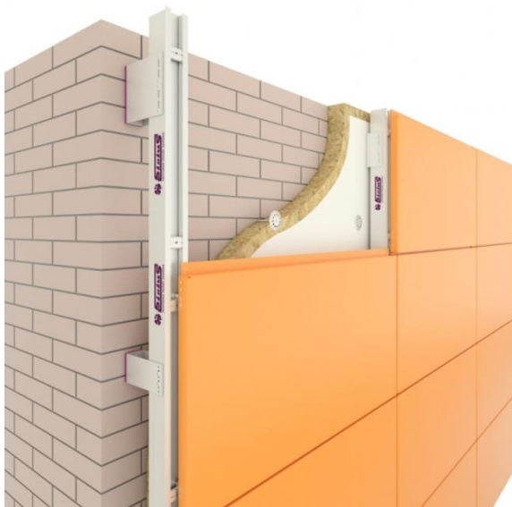
Рис. 45. Узел многослойной стены с воздушной прослойкой из легкобетонных блоков
