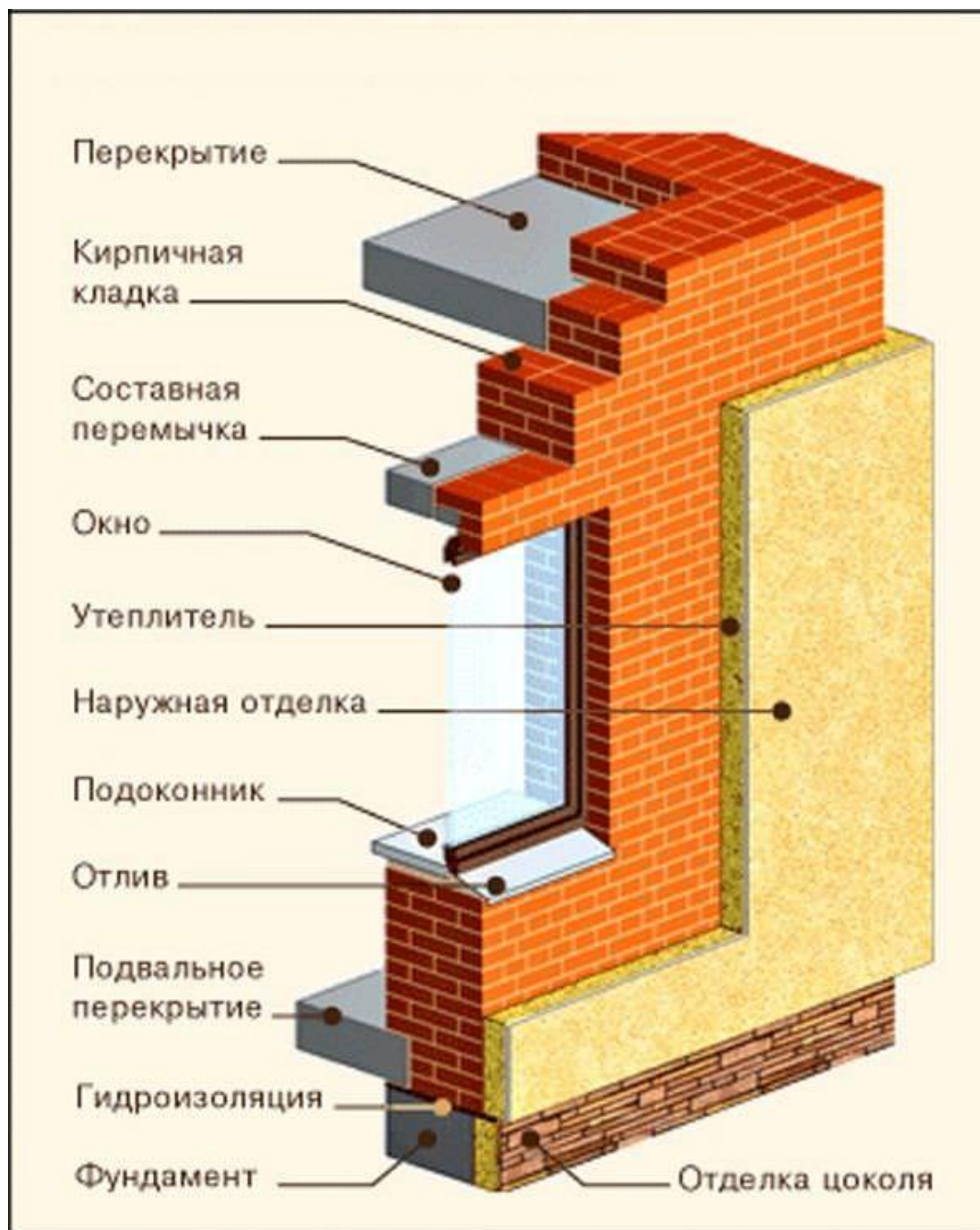
Рис.19. Принципиальная схема устройства кирпичной слоистой стены с утеплением снаружи
