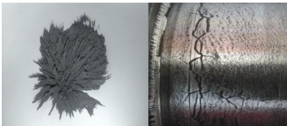
Рис. 6 Скопление порошка на дефектах шва
