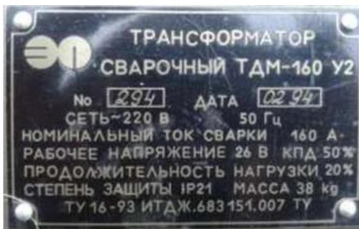
Рис. 21 Маркировка сварочного трансформатора
