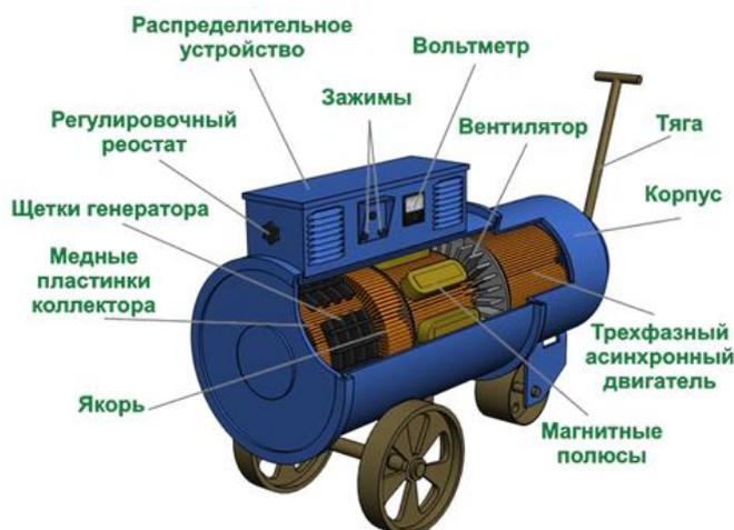
Рис.27 Устройство сварочного преобразователя ПСО-500
