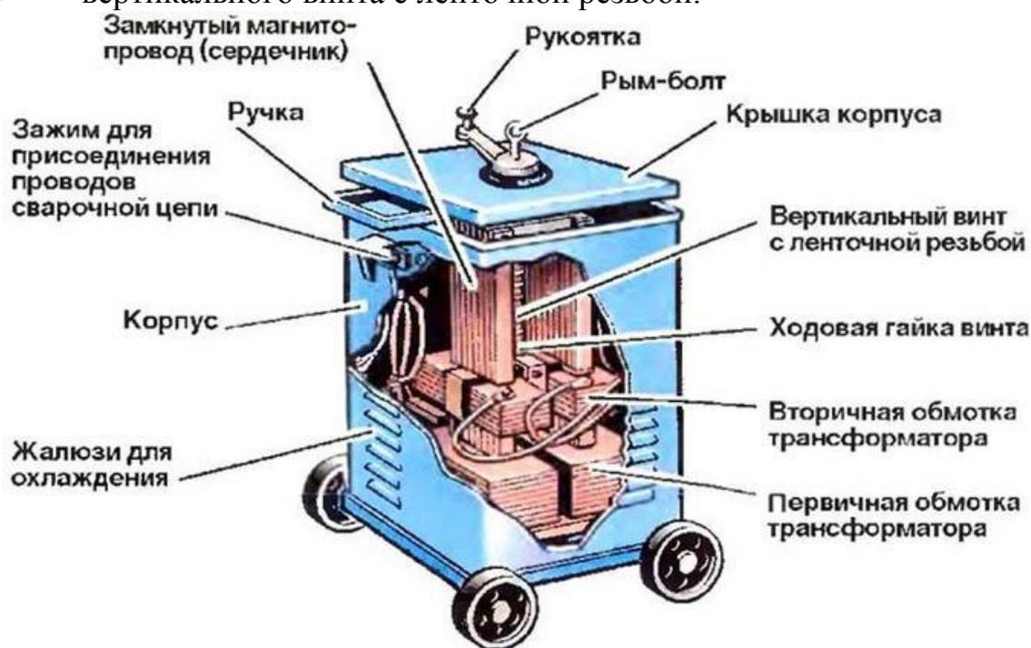
Рис.12 Устройство сварочного трансформатора
