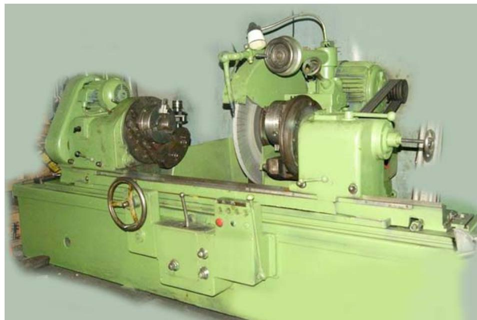
Шлифование шеек ведется на круглошлифовальных станках ЗА432 шлифовальными кругами для стальных валов Э46-60 СТ1-СТ25К, для чугунных — КЧ46СМ2-М25К размером ПП -900Х30Х305. Рекомендуемые режимы резания: скорость вращения шлифовального круга 25—30 м/с, коленчатого вала 10 — 12 м/мин для шатунных шеек и 18—20 м/мин для коренных шеек, поперечная подача Шлифовального круга 0,006 мм. При шлифовании необходимо выдерживать радиус галтелей и не увеличивать длину шатунных шеек.
