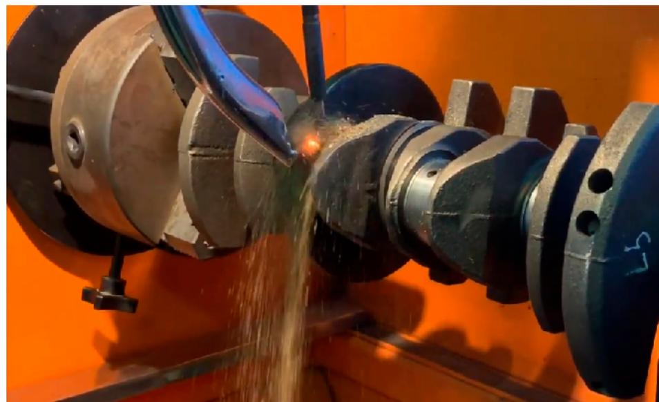
Шейки валов, вышедшие за пределы последнего ремонтного размера, восстанавливают наплавкой под слоем флюса АН-348А проволокой Нп-3ОХГСА с последующей нормализацией, проточкой шеек, упрочнением галтелей поверхностным пластическим деформированием, закалкой их ТВЧ, шлифованием и полированием под размер рабочего чертежа.
