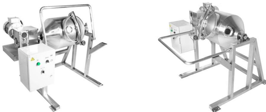
Предназначен для производства сливочного масла методом периодического сбивания.
