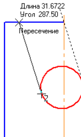
Рис. 61. Чертеж в процессе построения наклонной линии канавки
