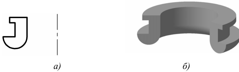
Рис. 31. Эскиз (а) и элемент (б), образованный операцией вращения
