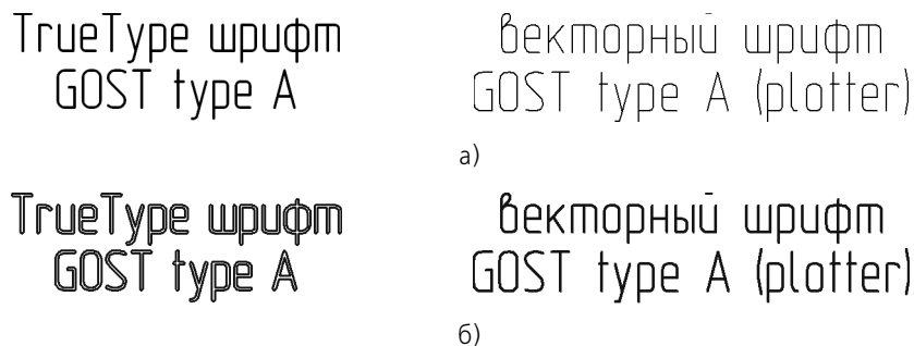
Рис. 3.4.24. Преобразование текстов в NURBS: а) исходные объекты – тексты, набранные TrueType-шрифтом и векторным шрифтом, б) результаты преобразования
