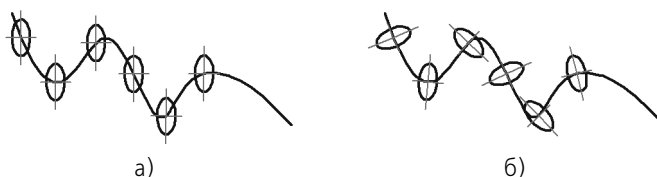
Рис. 3.4.13. Копирование эллипса вдоль сплайна: а) без доворота копий до нормали, б) с доворотом копий до нормали
