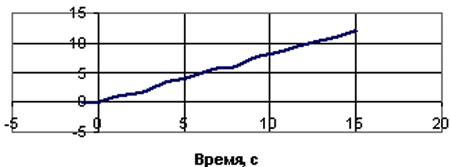
Рис. 10.16. Переходная характеристика объекта
