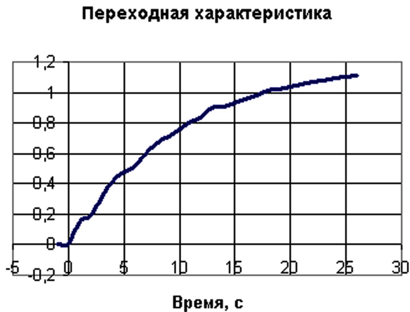
Рис. 10.17. Переходная характеристика объекта
