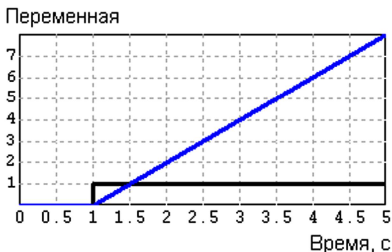
Рис. 10.11. Переходная функция интегратора
