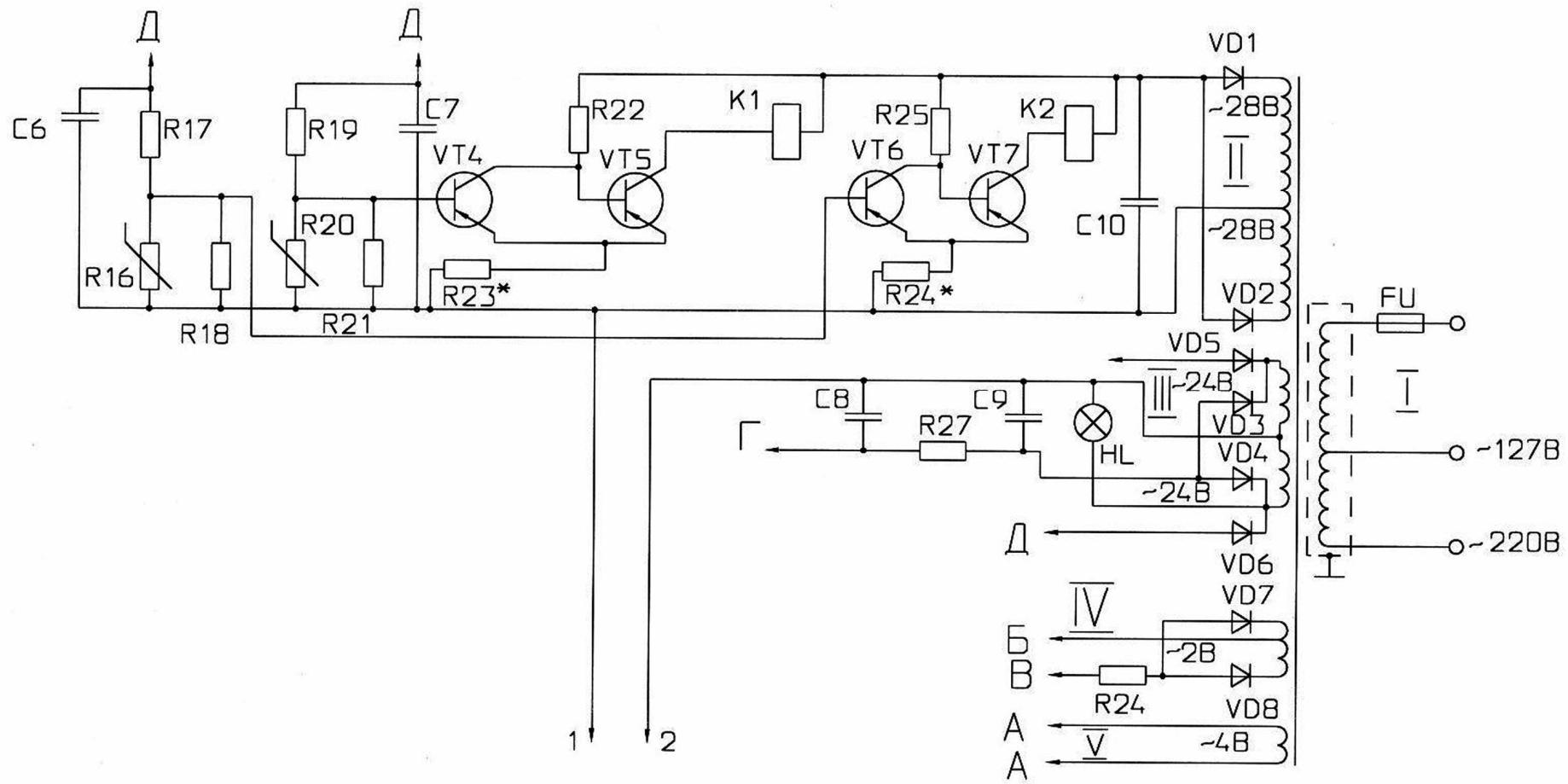
Рис. 8.1. Принципиальная электрическая схема терморегулятора ПТР-3-04 (начало)
