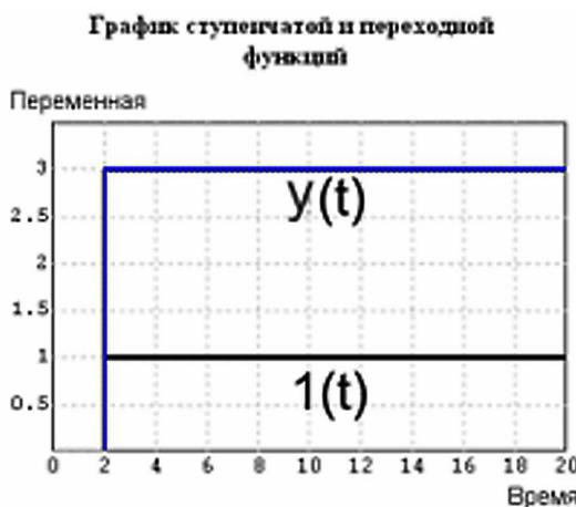
Рис. 10.4. Переходная функция пропорционального звена
