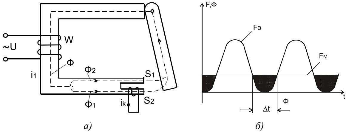
Рис. 4.6. Электромагнитное реле переменного тока:
