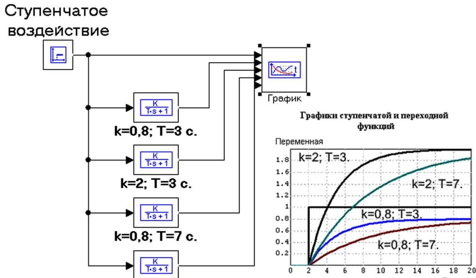
Рис. 10.12. Стенд для исследования апериодического звена
