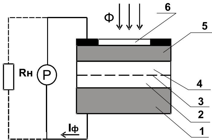
Рис. 2.3. Схема включения фотодиода
