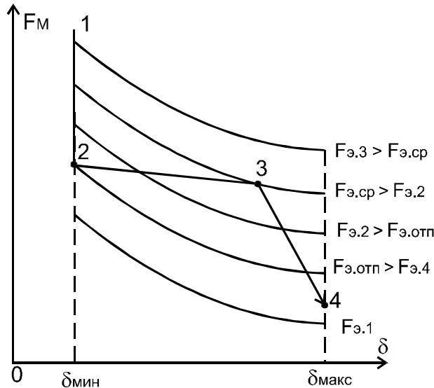
Рис. 4.4. Тяговые и механические характеристики электромагнитного реле
