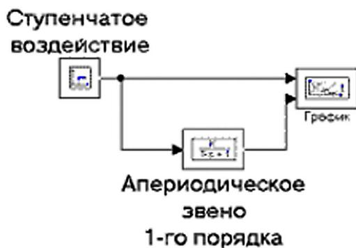
Рис. 10.2. Структурная схема стенда
