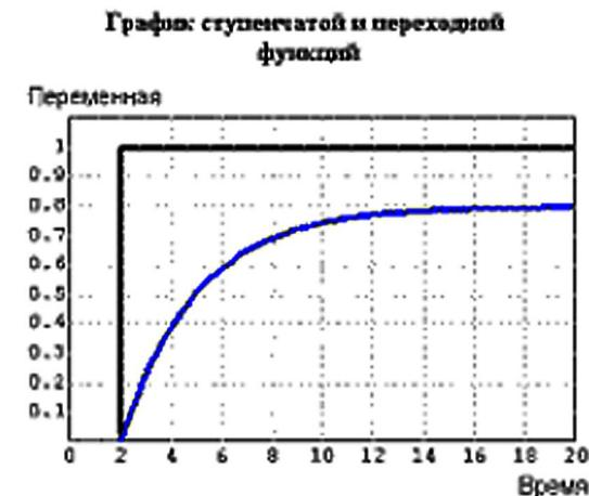
Рис. 10.3. Переходная характеристика апериодического звена 1-го порядка
