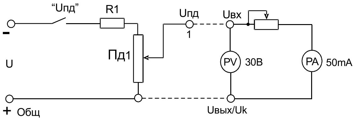
*Рис. 3.4. Принципиальная схема исследования нагруженного потенциометрического датчика*
