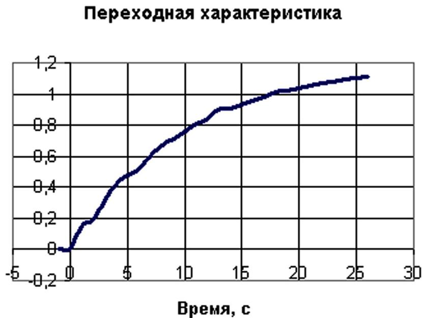
*Рис. 10.17. Переходная характеристика объекта*
