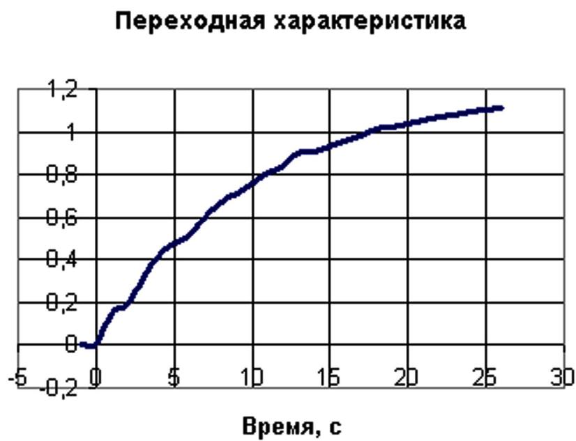
*Рис. 10.17. Переходная характеристика объекта*
