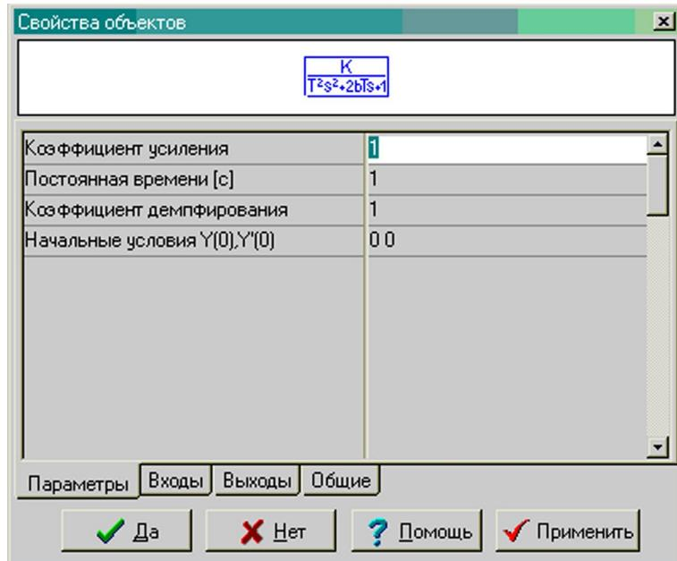
Рис. 10.15. Окно задания параметров колебательного звена
