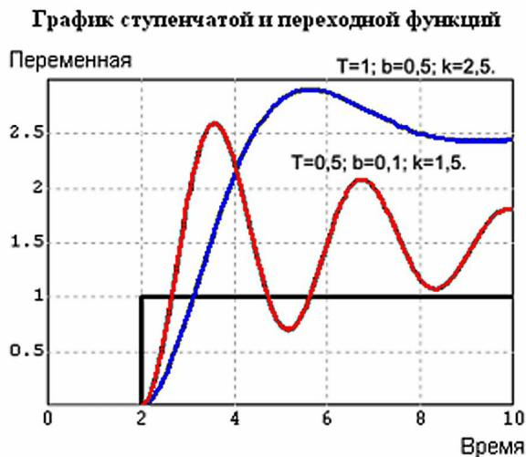
Рис. 10.8. Переходные функции колебательных звеньев
