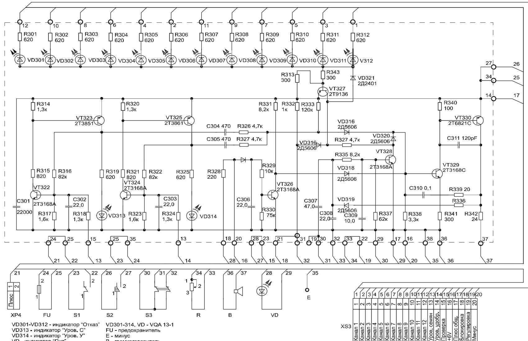
Рис. 9.2. Принципиальная электрическая схема пульта YCK
