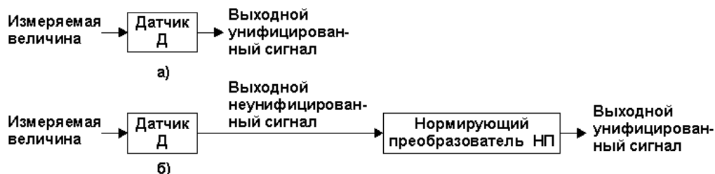
Рисунок 1.8 - Основные структурные схемы подключения первичных преобразователей
