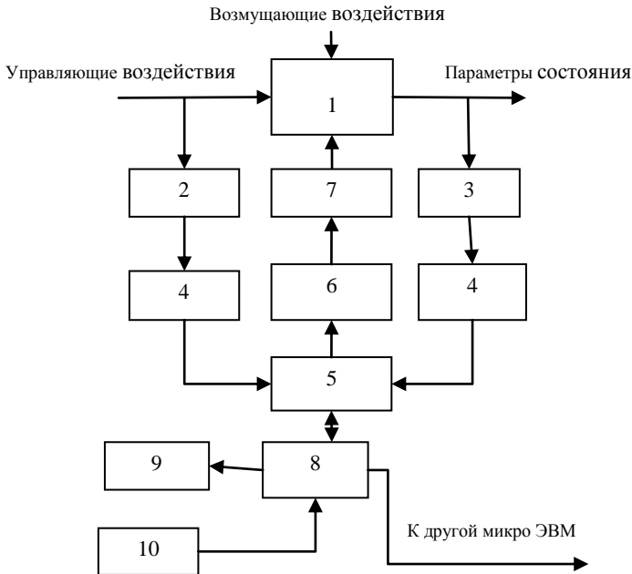
Рис. 1.4. Структурная схема микропроцессорной системы управления с микро-ЭВМ: 1 – технологический объект управления; 2 – измерительные преобразователи управляющих воздействий; 3 – измерительные преобразователи выходных параметров ОУ; 4 – измерительные контроллеры; 5 – управляющая ЭВМ; 6 – интерфейсные блоки связи с объектом; 7 – исполнительные механизмы; 8 – интерфейсные блоки связи с периферией; 9 – дисплей; 10 – пульт оператора
