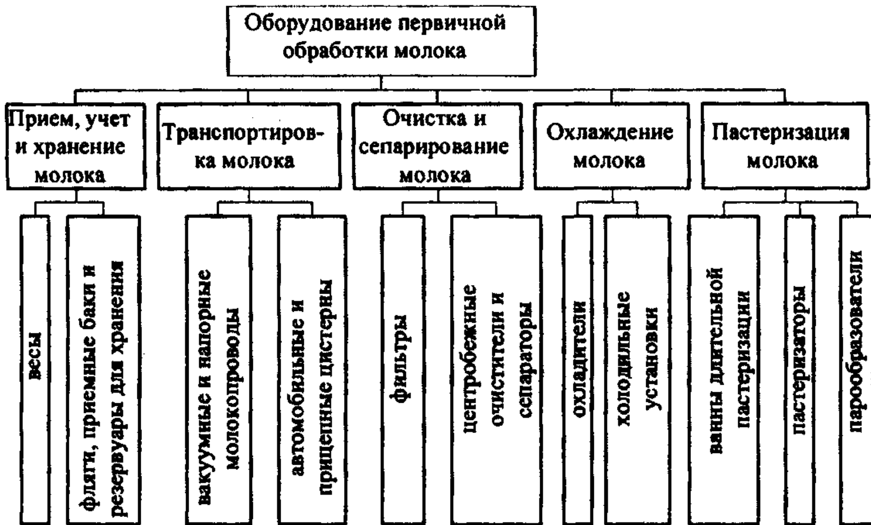
Рис. 35.1. Классификация оборудования первичной обработки молока
