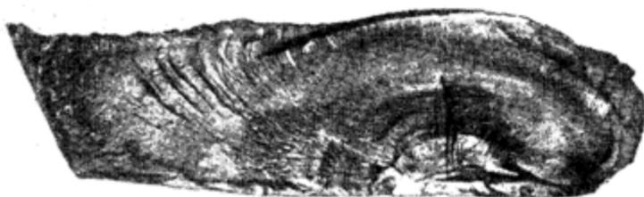
Рис. 2. Усталостный излом зуба шестерни
