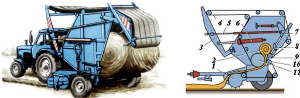
Рис. 8.22. Схема рабочего процесса пресс-подборщика ПРП-1,6:
