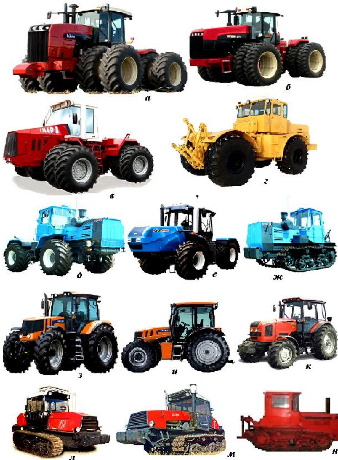
Рис. 2.1. Тракторы общего назначения:
