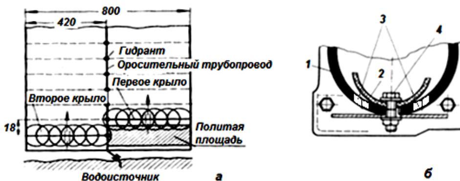
Рис. 7.6. Схема работы машины ДКШ-64 «Волжанка» (а) и общее устройство сливного клапана (б):
