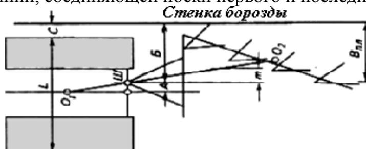
Рис. 3.4. Схема присоединения плуга к трактору
