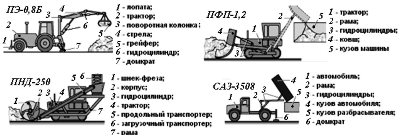
Рис. 5.3. Машины для погрузки и транспортировки удобрений
