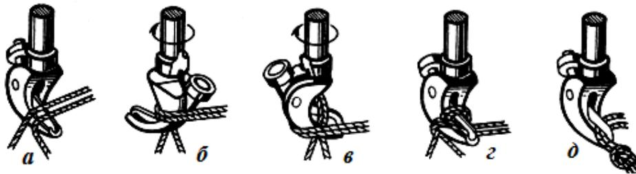
Рис. 8.19. Процесс образования узла при шпагатной обвязке тюков:
