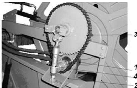
Рис. 9.10. Механизм привода мотовила:
