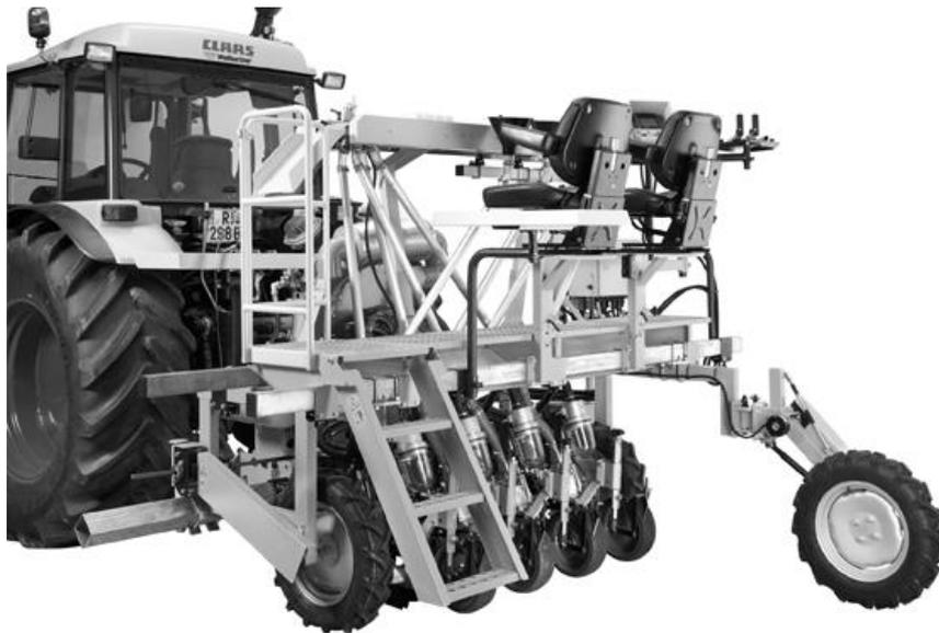
Рис. 14.12. Пропашная сеялка Monoseed DT
