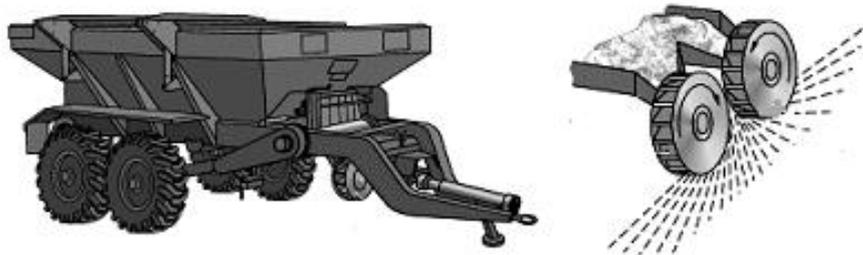
Рис. 5.6. Машина для внесения минеральных удобрений СТТ-10
