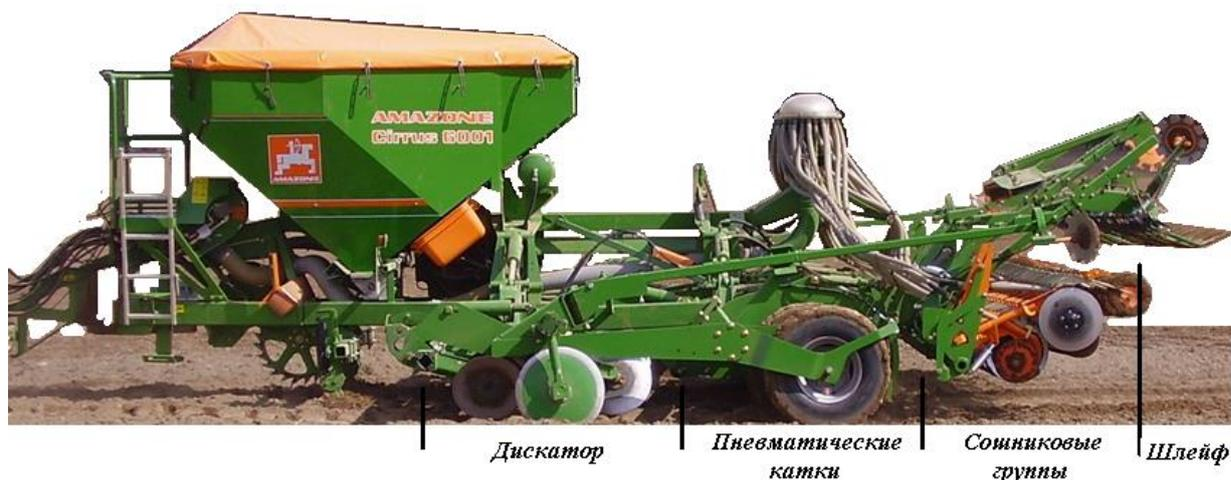
Рис. 3.33. Комбинированная почвообрабатывающе-посевная машина Cirrus Special фирмы Amazone
