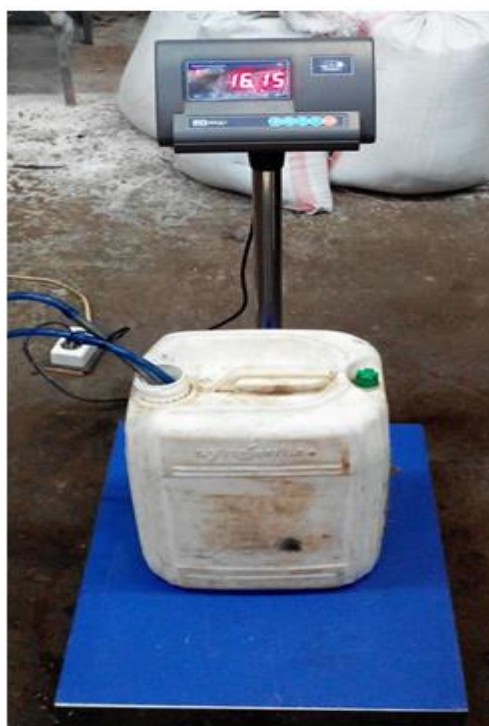
Рис. 3.12 Измерительные приборы: напольные электронные весы для определения расхода топлива
