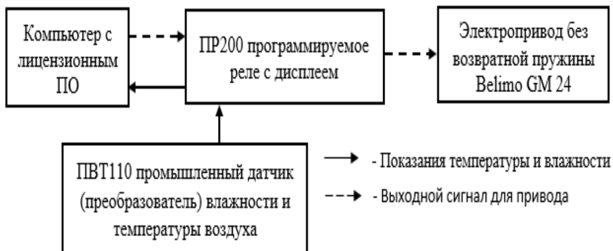
Рис. 3.23 Принцип работы автоматизированного управления клапаном-смесителем системы рециркуляции отработавшего агента сушки аэродинамического устройства для сушки сыпучих материалов.
