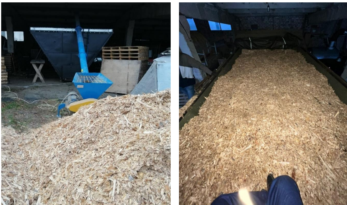
Рис. 4.5 Загрузка щепы и заполненная березовой щепой камера сушки аэродинамического устройства для сушки сыпучих материалов
