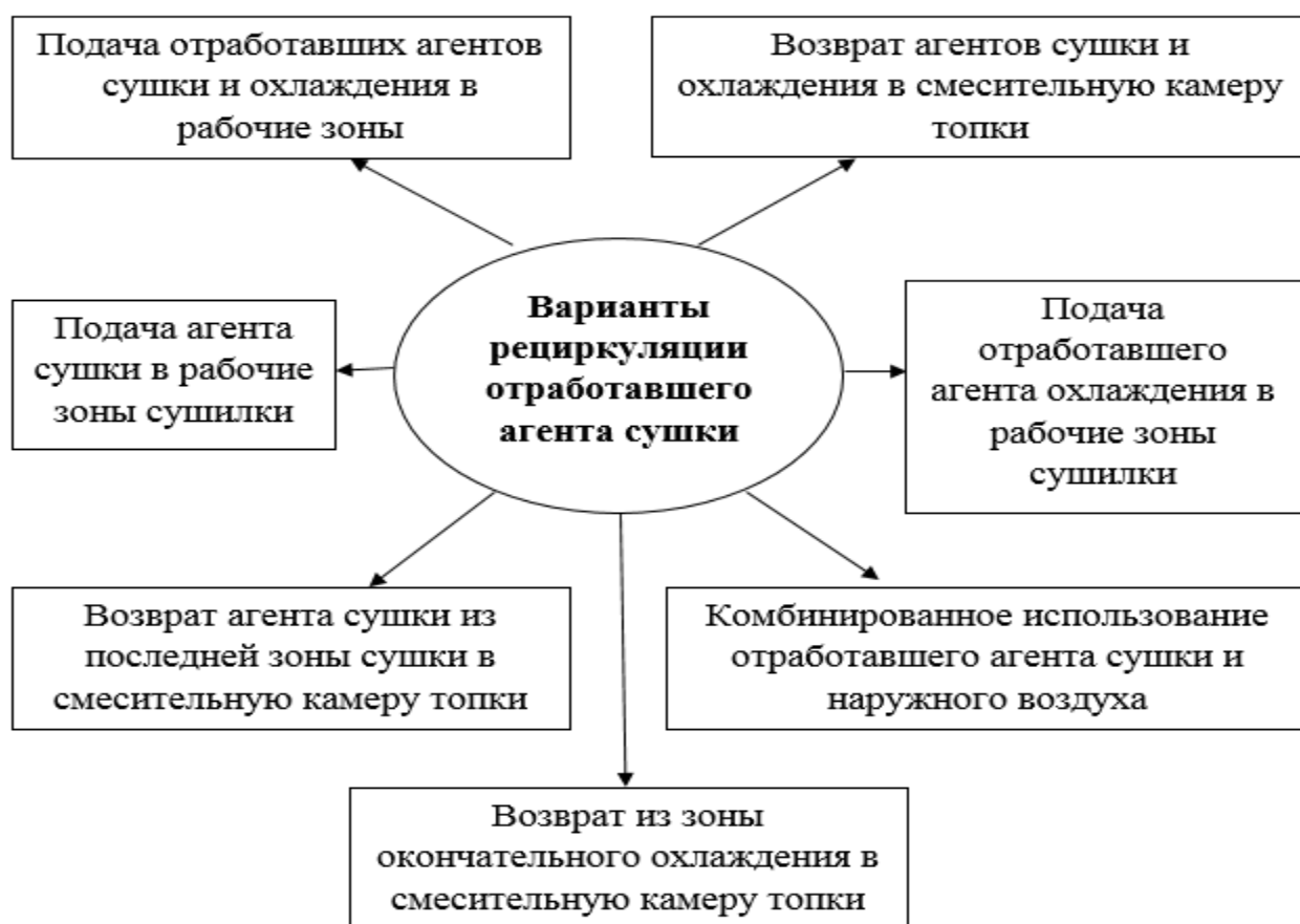
Рисунок 1.4 - Варианты рециркуляции отработавшего агента сушки
