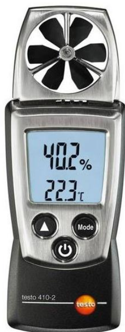
Рис.3.8 Измерительные приборы: карманный анемометр с крыльчаткой и сенсором влажности Testo 410-2
