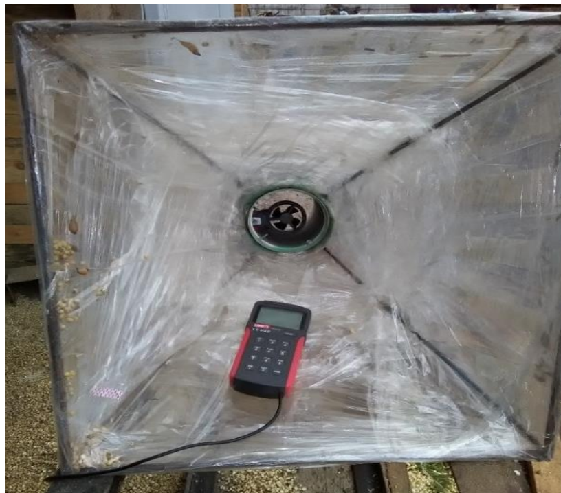
Рис.3.7 Измерительные приборы: электронный анемометр UNI-T UT362 с конфузуром, вид снизу, основание пирамиды 500*500 мм и высотой 500 мм, диаметр воздуховода 120 мм длинна 400 мм
