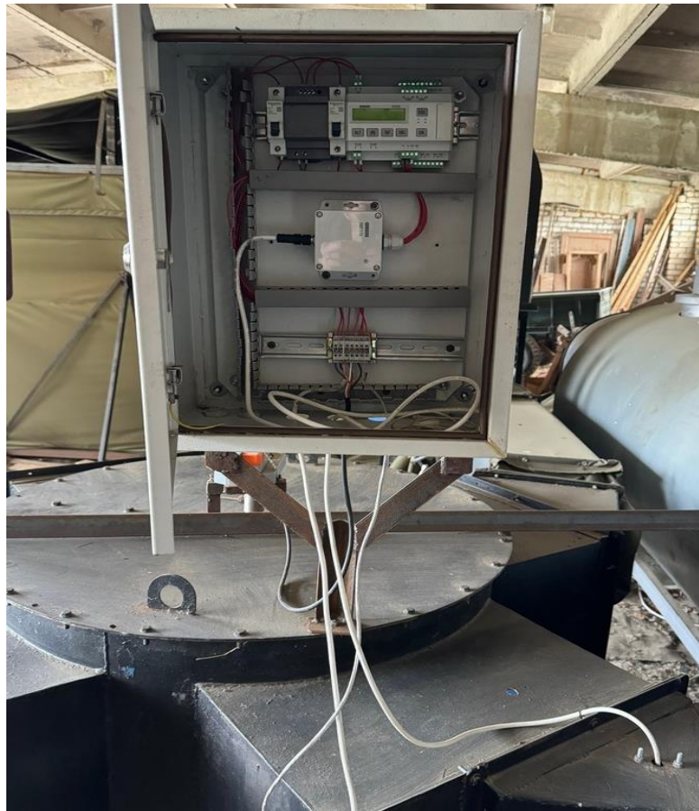
Рис. 3.28 Комплектующие автоматизированного управления клапаном-смесителем системы рециркуляции отработавшего агента сушки аэродинамического устройства для сушки сыпучих материалов в сборе
