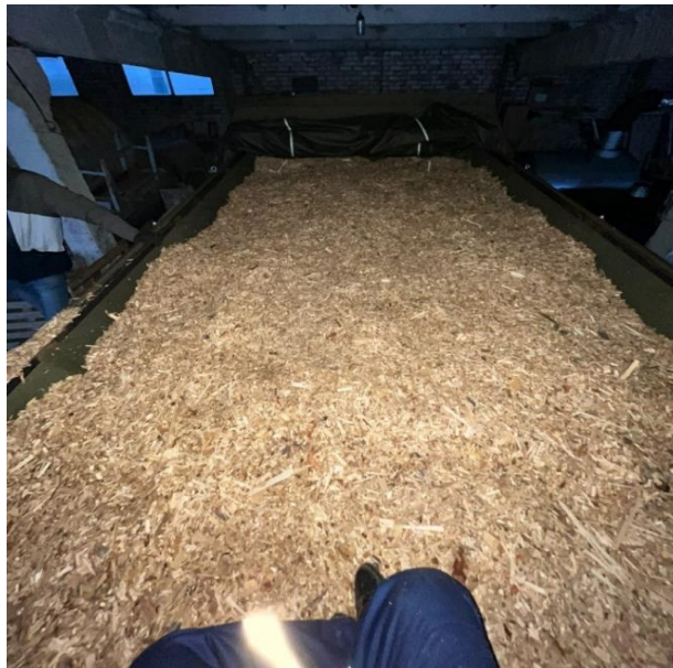
Рис. 31 - Заполненная березовой щепой камера сушки аэродинамического устройства для сушки сыпучих материалов
