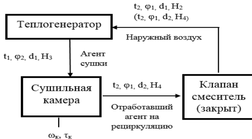
Рис. 6 - Схема работы системы рециркуляции агента сушки при полной его смене
