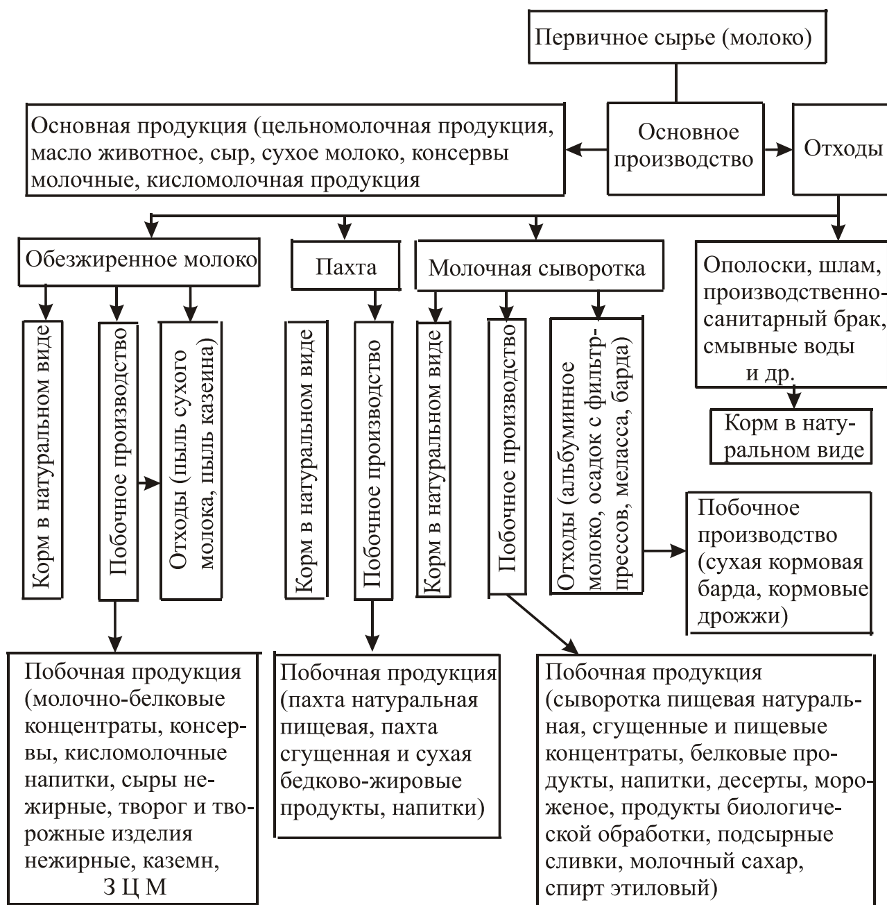
Рисунок 11.2 — Схема образования и использования ВСП в молочной отрасли.
