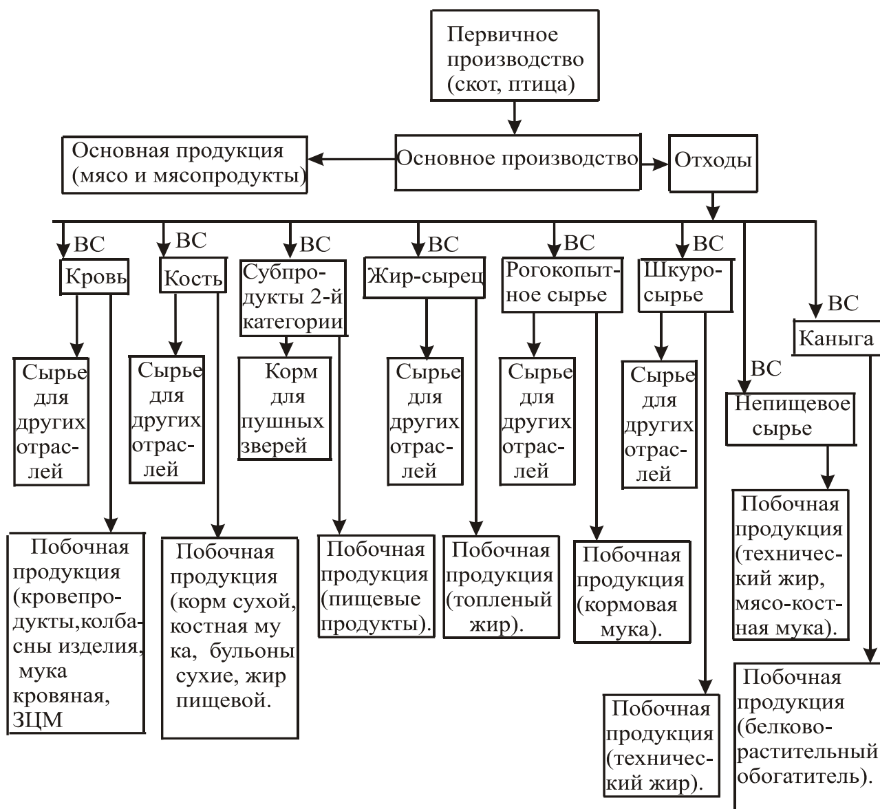
Рисунок 11.1 — Схема комплексного использования сырья в мясной отрасли
