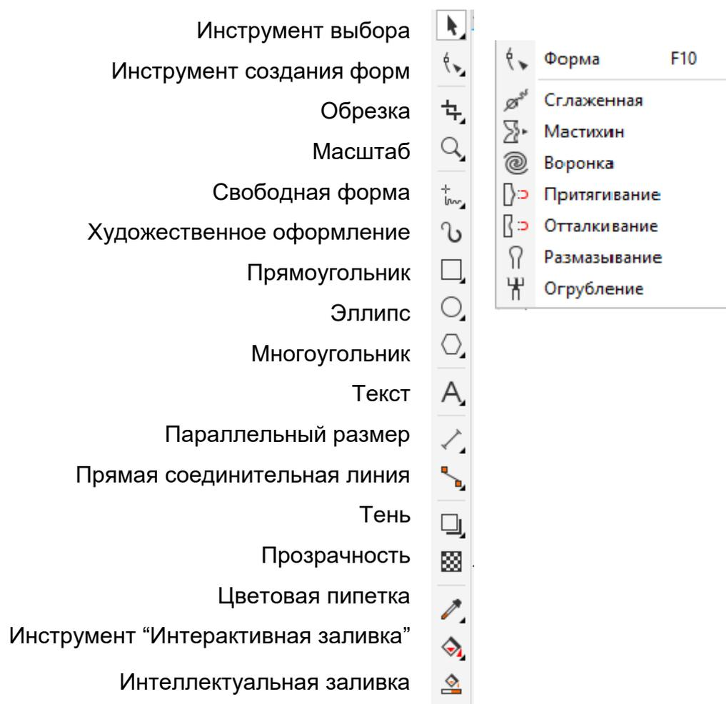
Рис. 1.2. Инструментальный состав панели *Набор инструментов*
