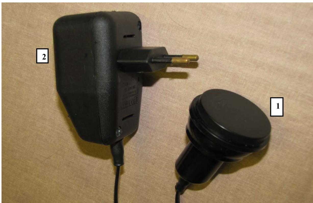
Рисунок 18 – Аппарат ультразвуковой низкочастотный «Ретон»: 1 – излучатель; 2 – электронный блок прибора
