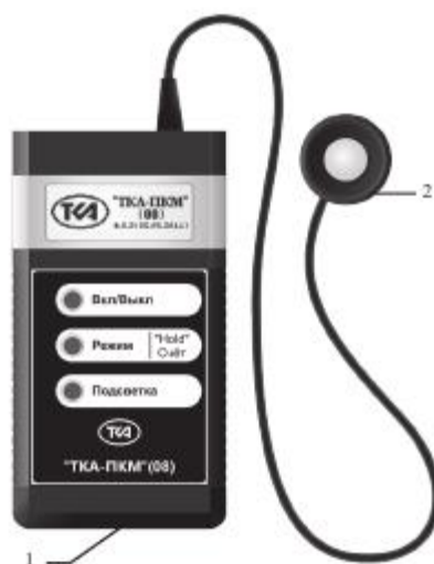
Рисунок 2. Внешний вид прибора ТКА –ПКМ (08)
