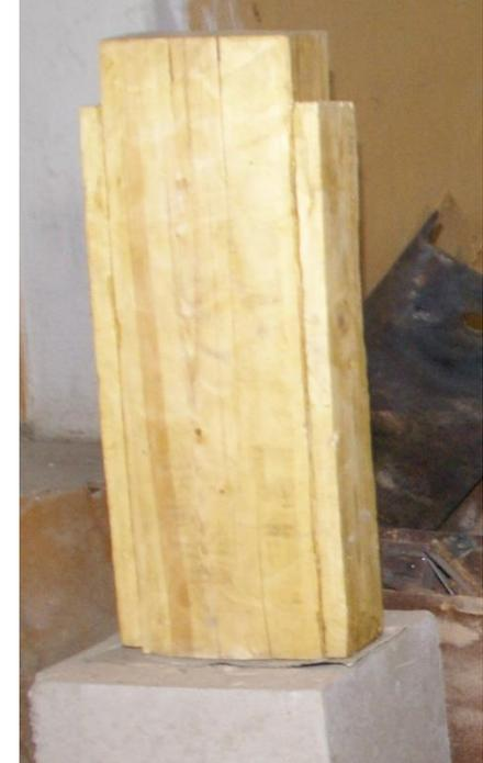
Защемление колонны в фундаменте с помощью вклеенных стержней
