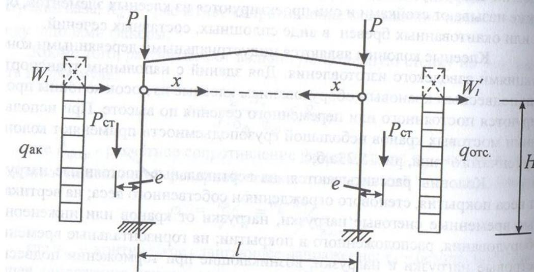
Поперечное сечение колонн принимают: высоту  $h_k = (1/8...1/15)H$ ; ширину  $b \geq h_k/5$ . Колонна в плоскости поперечника здания работает на сжатие с изгибом, а в продольной плоскости - на центральное сжатие.
