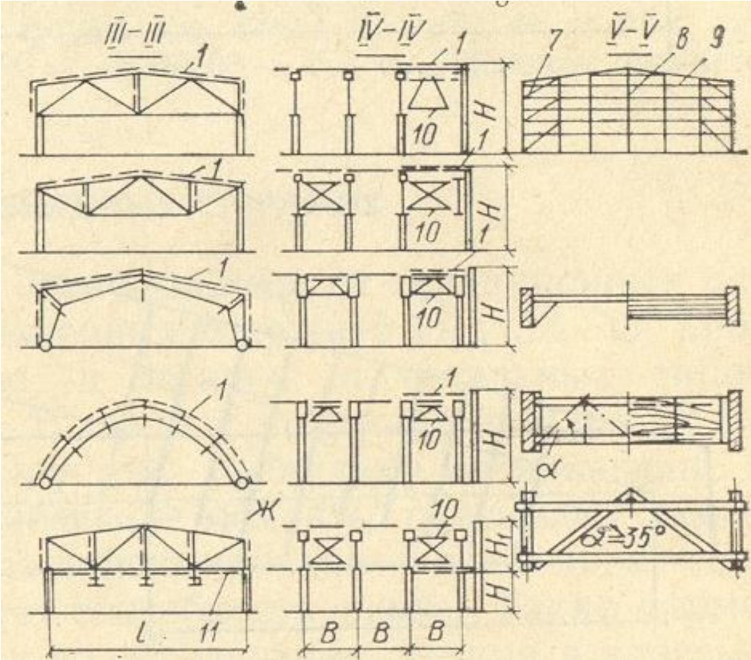
Учитывая податливость соединений, при проверке устойчивости нижнего сжатого пояса конструкций покрытия за его расчетную длину следует принимать расстояние между связями, **увеличенное на 25%**.
