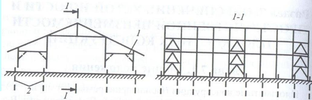
Пример защемления деревянных стоек в грунте с помощью пасынков (металлических или железобетонных)
