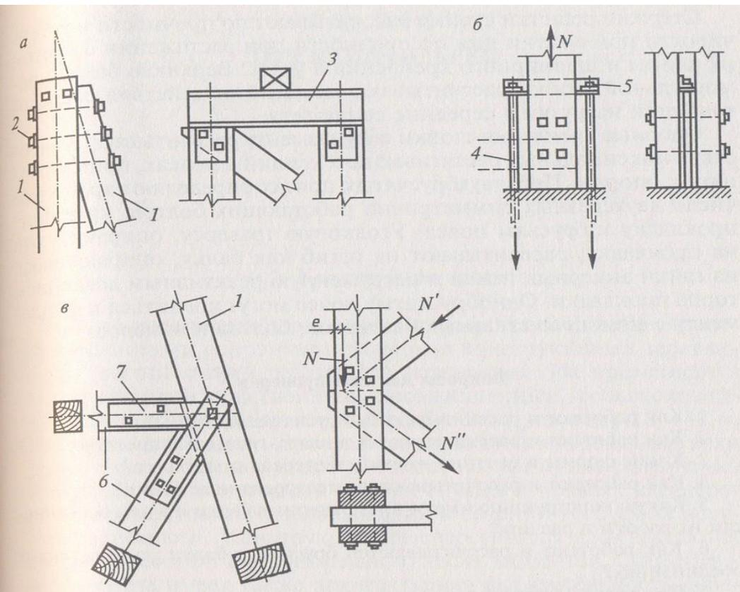
Двухбрусчатые пояса с короткими прокладками имеют большую жесткость в направлении из плоскостей стойки, а также зазоры, что упрощает крепление к ним решетки из брусьев или толстых досок. Однобрусчатые пояса менее трудоемки в изготовлении, но для крепления к ним стержней решетки требуются стальные накладки. Решетка этих стоек имеет обычно раскосно-стоечную схему.
