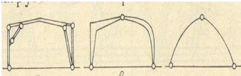
3. Поперечную неизменяемость здания обеспечивают простейшими комбинированными и подкосными системами, рамными системами или арочными конструкциями, передающими распор непосредственно на фундаменты. Продольную неизменяемость обеспечивают как и в предыдущем случае применением связей.
