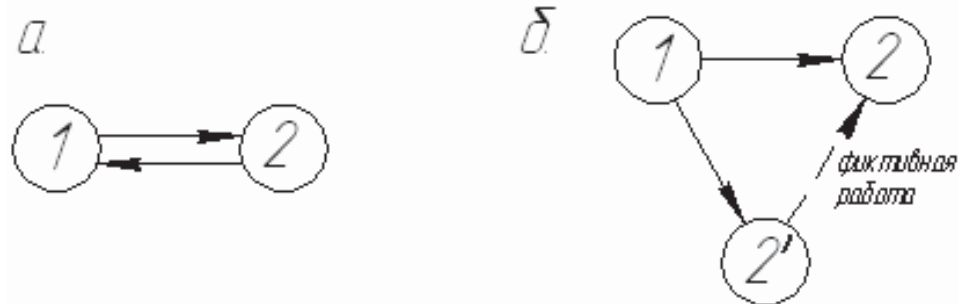
Рисунок 4.4 - Пример неправильного (а) и правильного (б) построения сетевого графика
