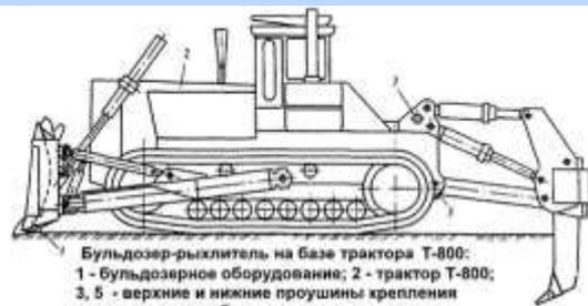
Бульдозер-рыхлитель на базе трактора Т-800:
