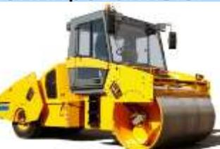
**По принципу действия** различают два вида катков: статические и вибрационные. **Статический каток** движется по уплотняемому материалу, оказывая на проходимые поверхности стандартное давление. А **вибрационный каток** воздействует на уплотняемый слой как за счет силы тяжести, так и воздействуя на него в силу периодических колебаний.
