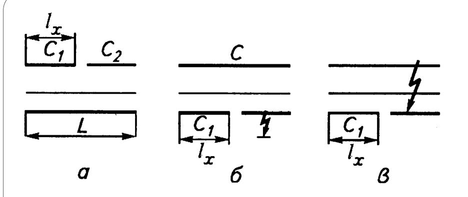
Рис. 8.2. Виды повреждений кабеля с обрывом жил: **а** - обрыв одной жилы кабеля;
