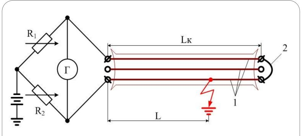
Рис. 7.1. Схема определения места повреждения *петлевым методом:*
