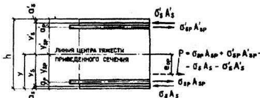
Черт. 2.1 Схема усилий предварительного напряжения арматуры в поперечном сечении железобетонного элемента
