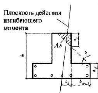
Черт.3.6. Тавровое сечение со сжатой зоной, заходящей в наименее растянутый свес полки
