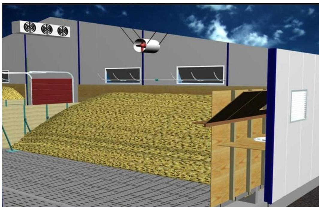
*Рис. 2.15. Вентиляционная камера с подпольным вентилированием*
