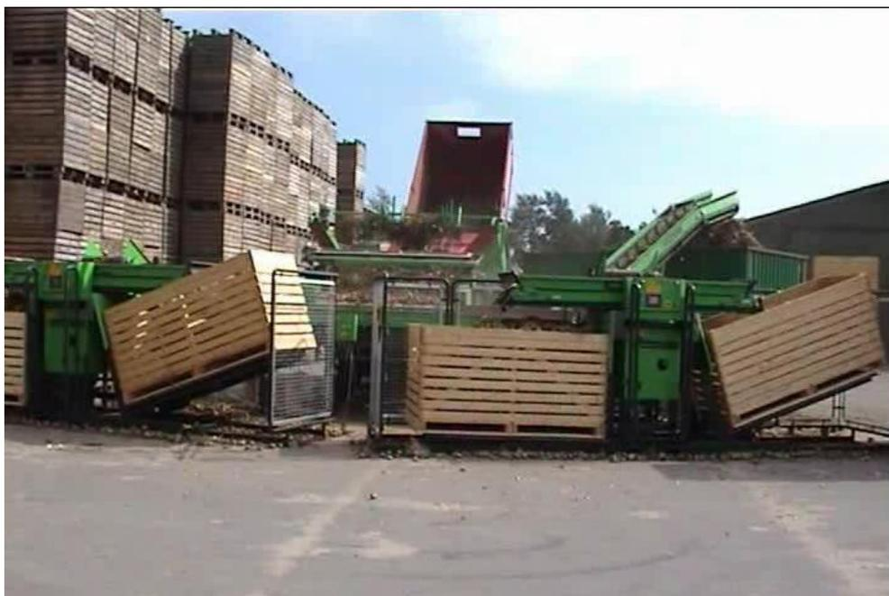
*Рис. 2.11. Машина для загрузки контейнеров*
