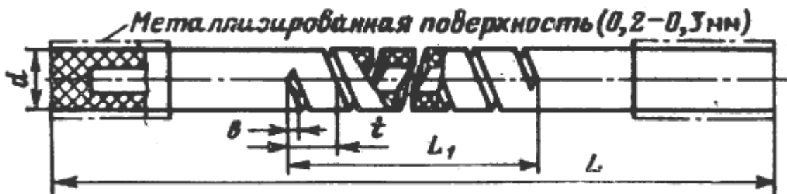
Рис. 1.36 – Электронагреватель хромитлантановый спиральный
