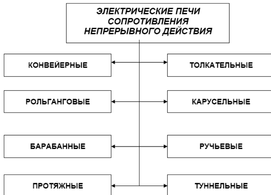
Рис. 2.16. Основные виды электрических печей сопротивления (наиболее распространенные)
