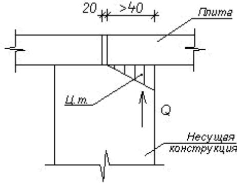
**Рисунок 4. К определению расчетного пролета плиты**
