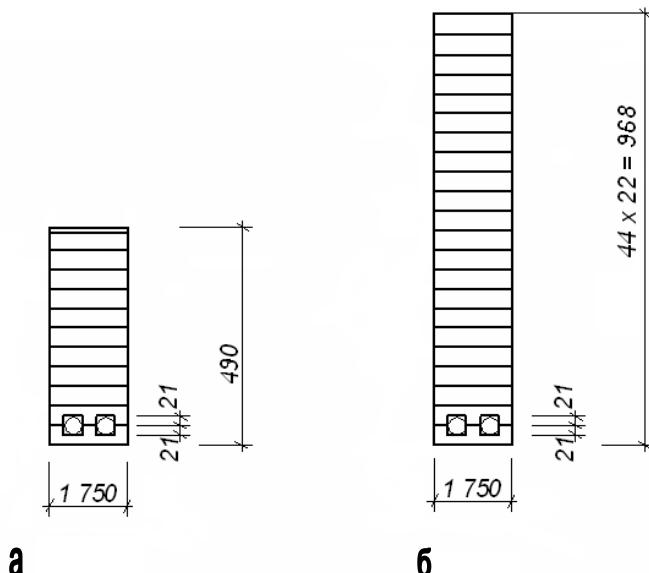
**Рисунок 15. Поперечные сечения kleедощатых армированных балок с одиночной арматурой ( а – на опоре; б – в середине пролета).**
