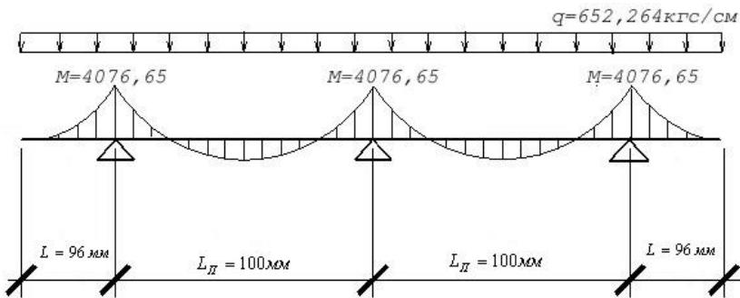
**Рисунок 53. Схема работы опорного листа**
