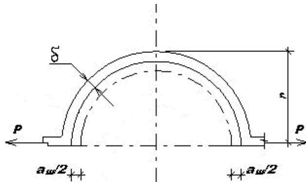
**Рисунок 7. Расчетная схема компенсатора**
