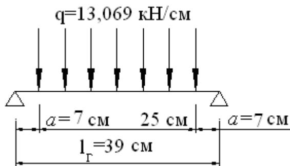
**Рисунок 39. Расчетная схема траверсы опорного узла на тяжах**
