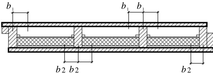
**Рисунок 2. Поперечное сечение каркасной плиты**
