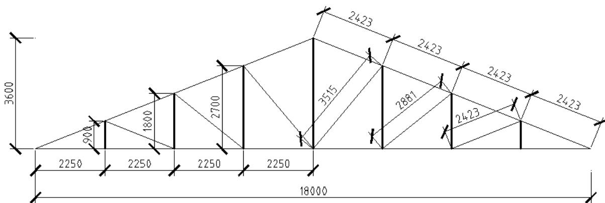
Рисунок 33. Геометрические размеры фермы
