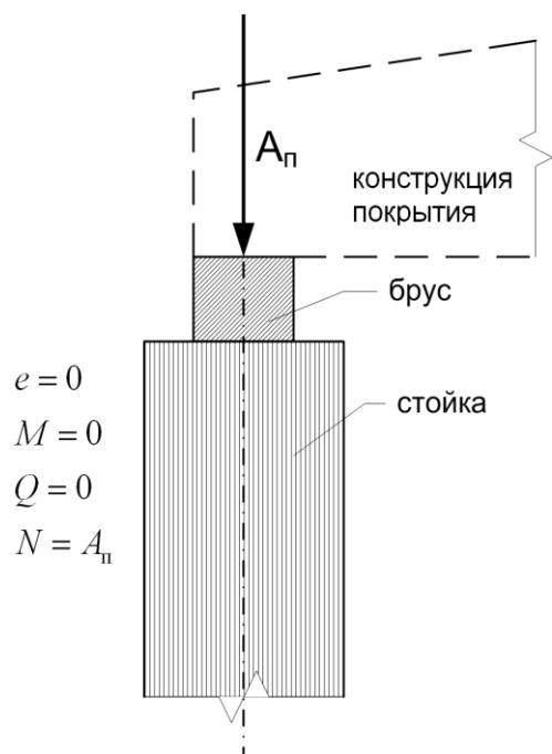
**Рисунок 68. Нагрузка на стойку от покрытия**
