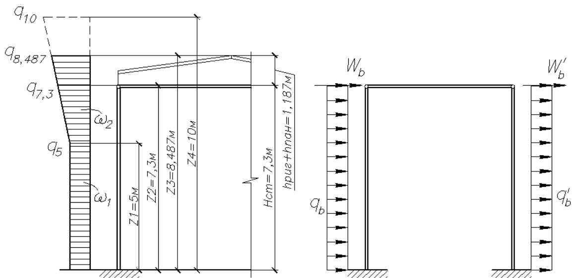
**Рисунок 70. Ветровая нагрузка на раму**
