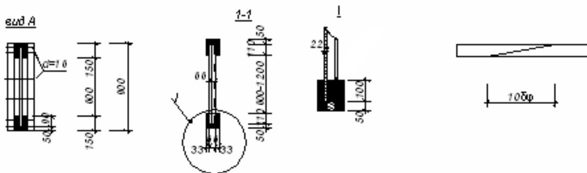
**Рисунок 17. Клееванерная балка с волнистой стенкой:**
