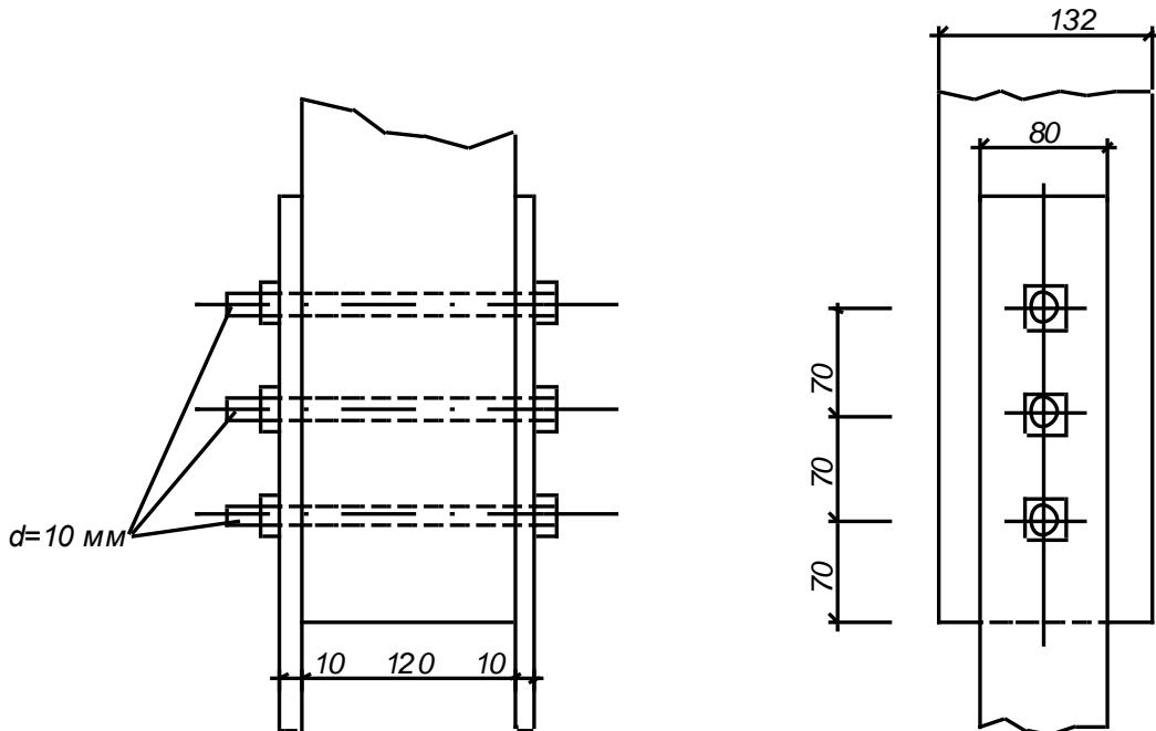
**Рисунок 30. Крепление стальных пластинок-наконечников к раскосам**
