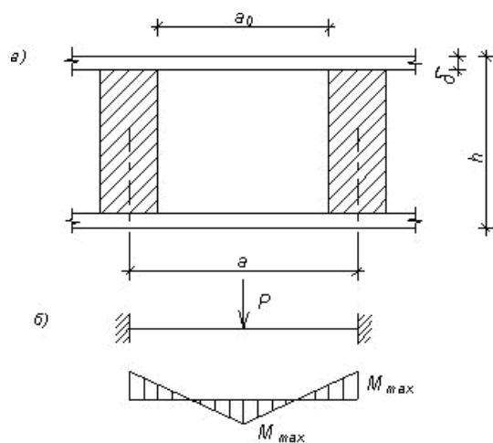
**Рисунок 9. К расчету верхней обшивки клееванерной плиты**
