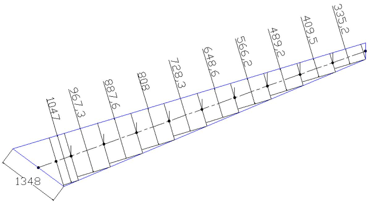
**Рисунок 59. Схема определения высоты сечения ригеля**
