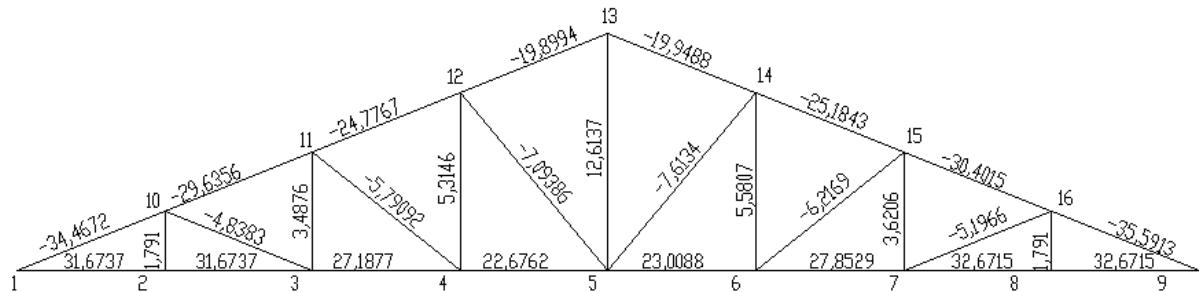
**Рисунок 37. Усилия в стержнях фермы [т]**
