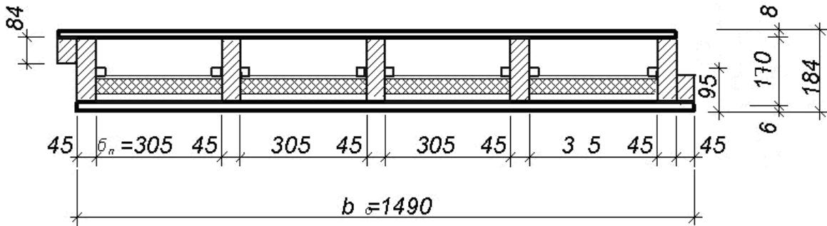
**Рисунок 10. Поперечное сечение клееванерной плиты**
