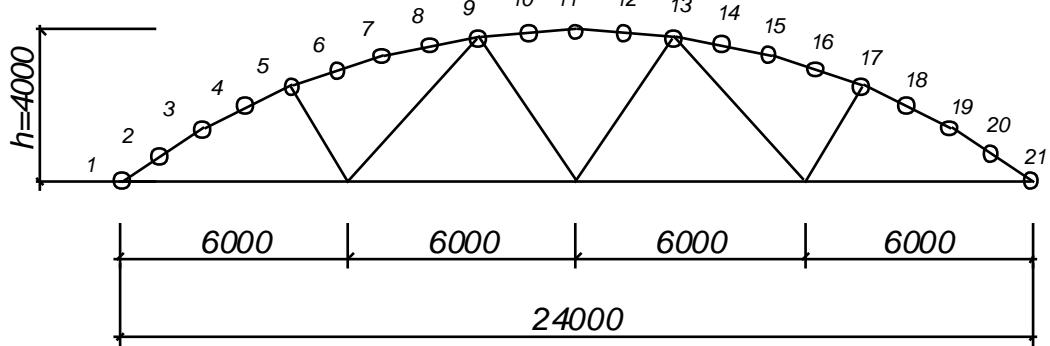
**Рисунок 29. Расчетная схема фермы**
