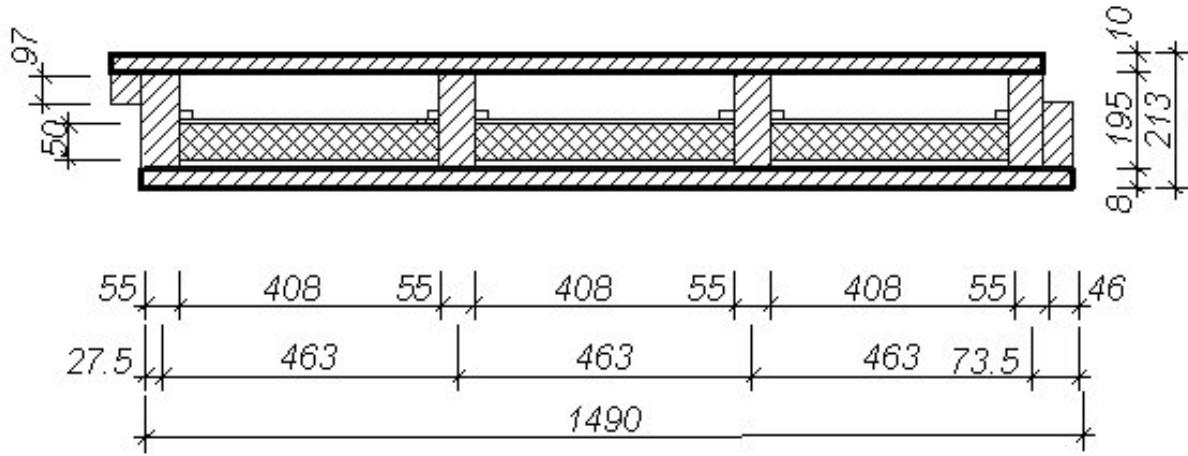
**Рисунок 1. Поперечное сечение асбестоцементной плиты**
