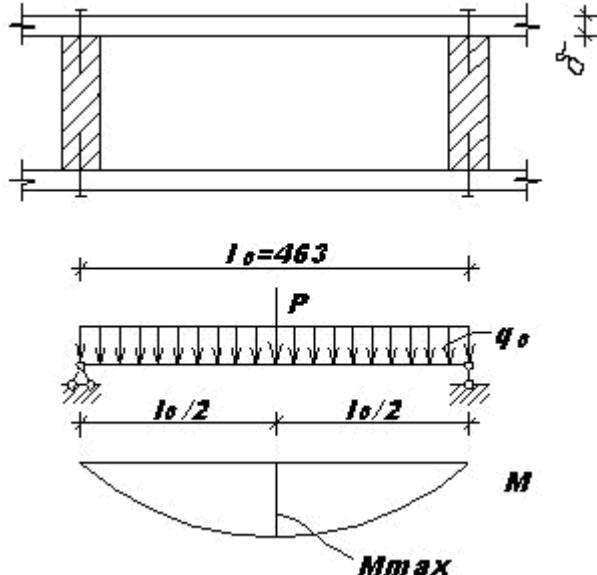
**Рисунок 5. К расчету верхней обшивки асбестоцементной плиты**
