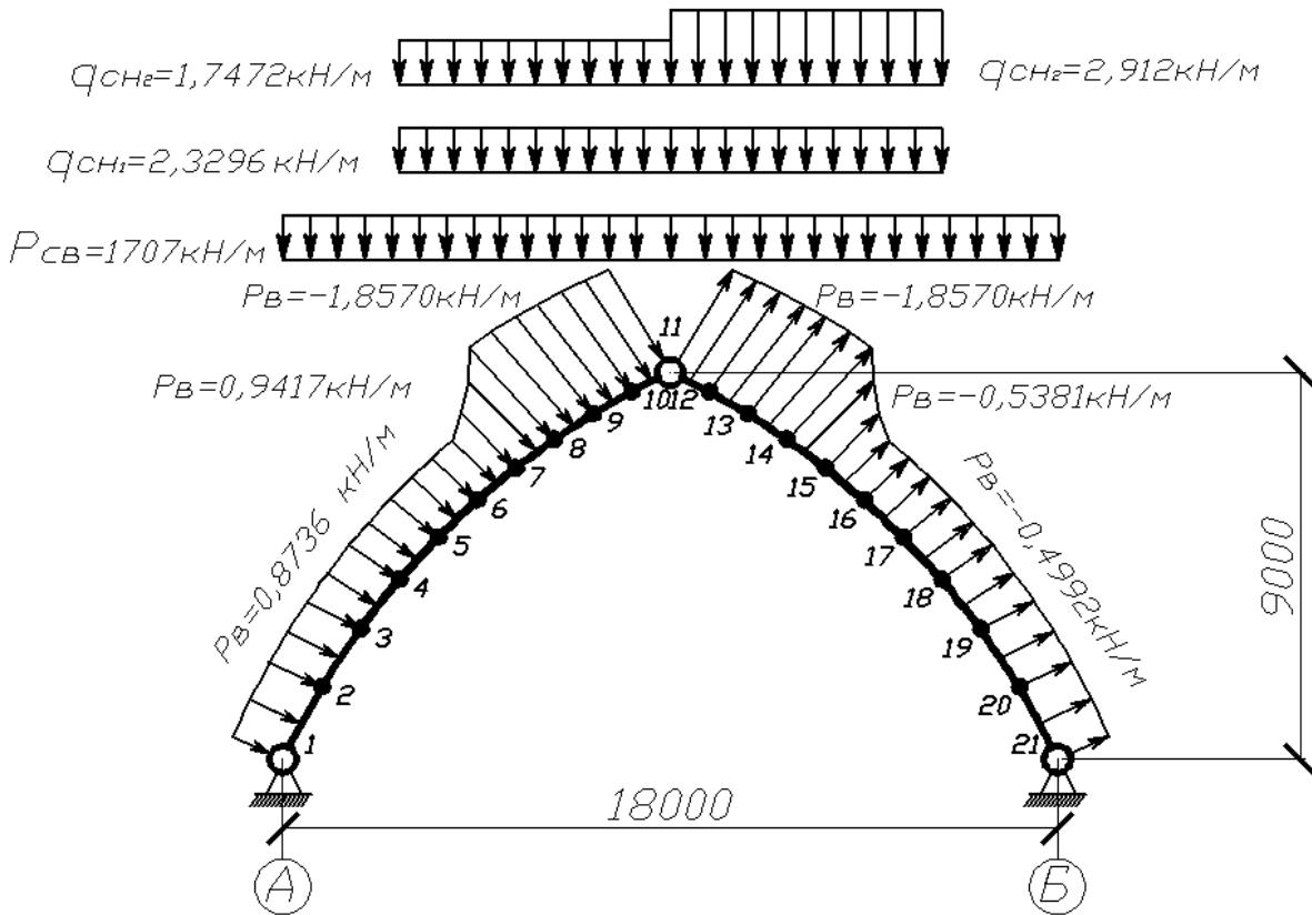
**Рисунок 47. Расчётная схема арки и действующие на неё временные и постоянные нагрузки**
