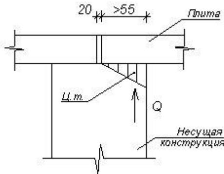
**Рисунок 11. К определению расчетного пролета плиты**
