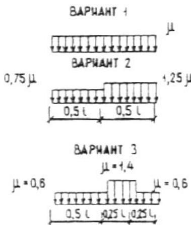
Варианты 2 и 3 следует учитывать для зданий с двускатными покрытиями (профиль  $\delta$ ), при этом вариант 2 — при  $20^\circ \leq \alpha \leq 30^\circ$ ; вариант 3 — при  $10^\circ \leq \alpha \leq 30^\circ$  только при наличии ходовых мостиков или аэрационных устройств по коньку покрытия.
