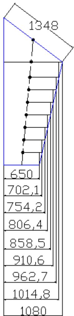
**Рисунок 58. Схема определения высоты сечения стойки**
