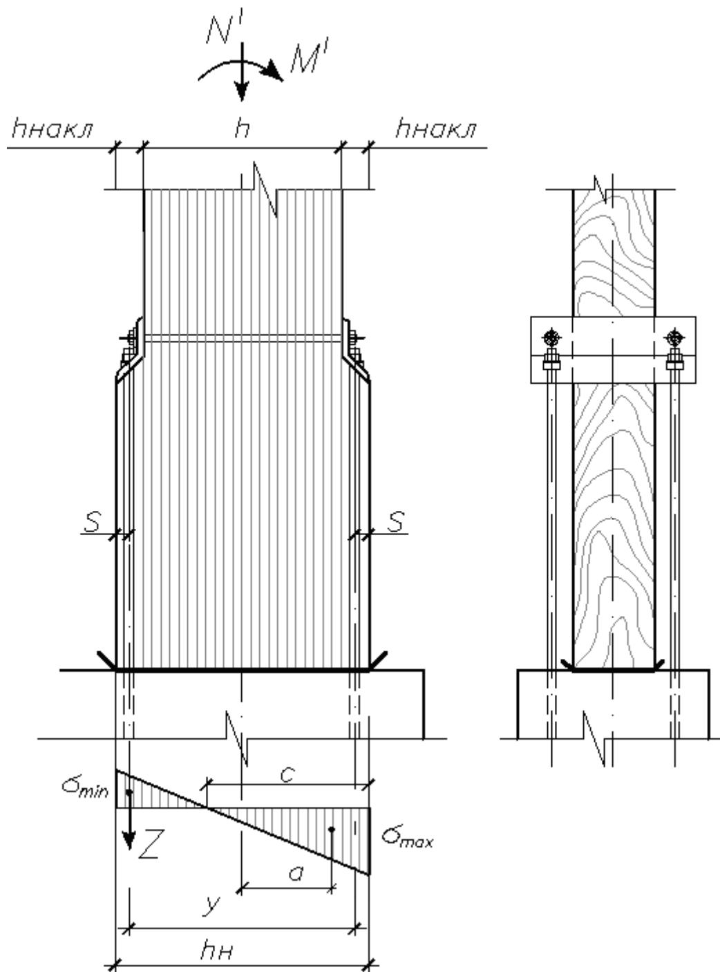
**Рисунок 75. Узел сопряжения стойки с фундаментом**
