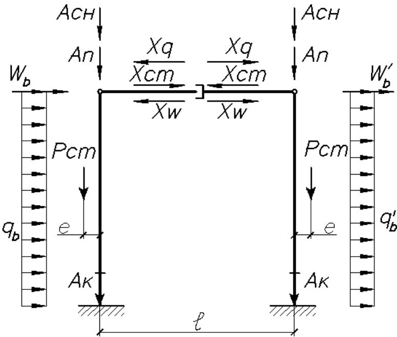
**Рисунок 71. Расчетная схема рамы**
