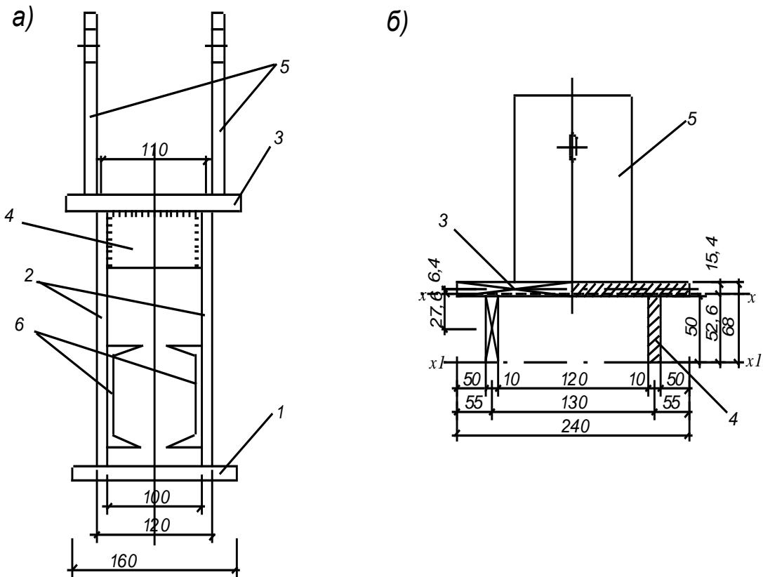
**Рисунок 31. Сварной башмак опорного узла**
