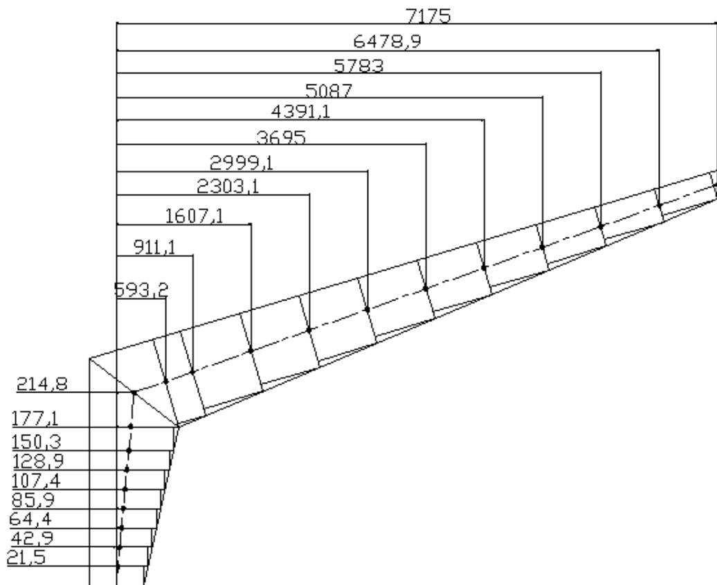
**Рисунок 56. Схема определения координаты  $x$  сечения**
