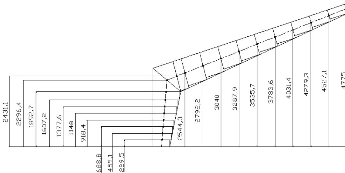
**Рисунок 57. Схема определения координаты  $z$  сечения**
