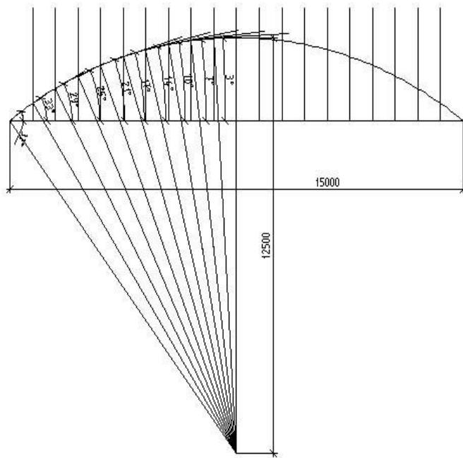
**Рисунок 50. Геометрические параметры арки**
