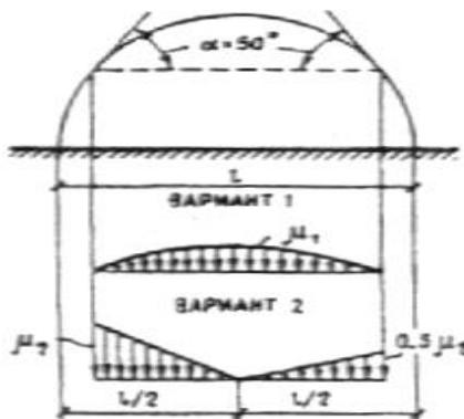
**Рисунок 28. Схема загружения фермы по двум вариантам**
