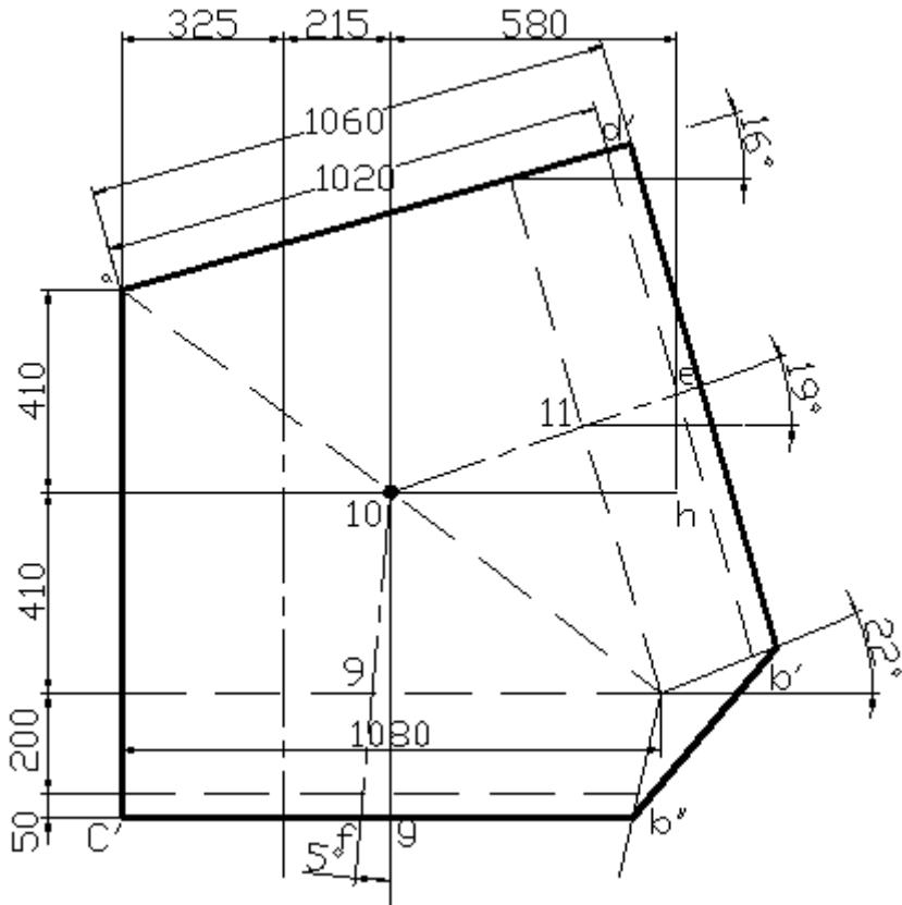
**Рисунок 66. Схема карнизного узла к определению размеров**
