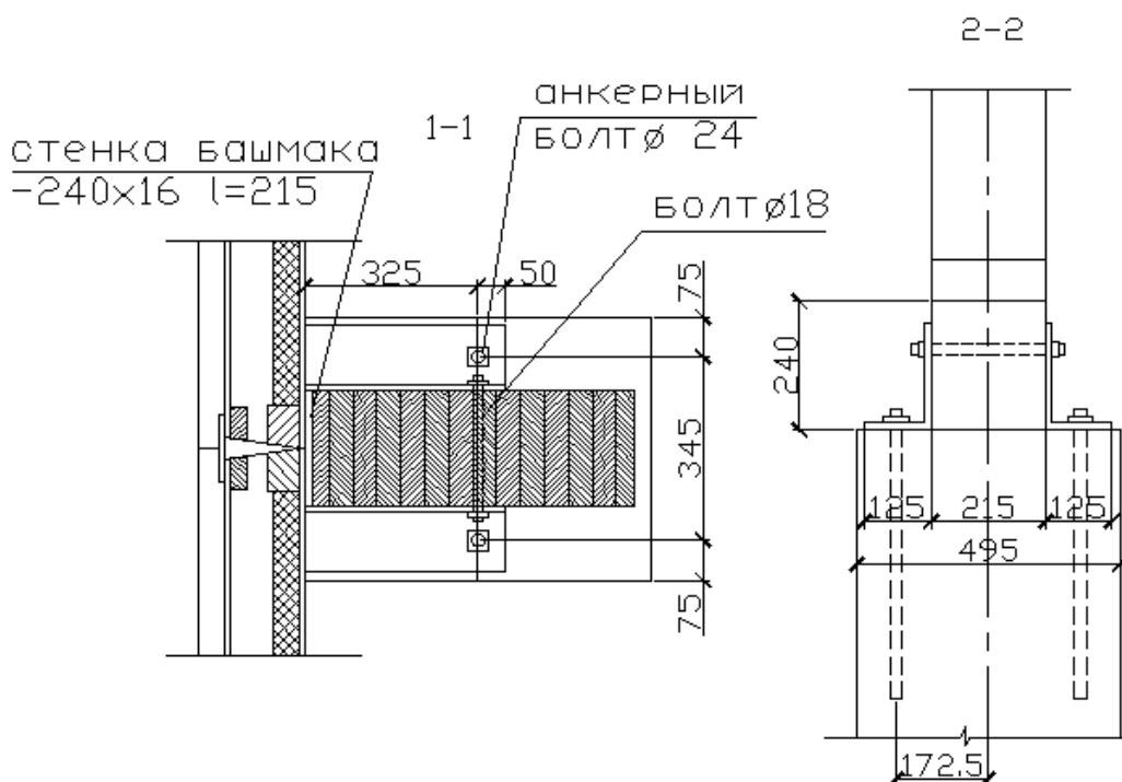
**Рисунок 64. Опорный узел(разрезы)**
