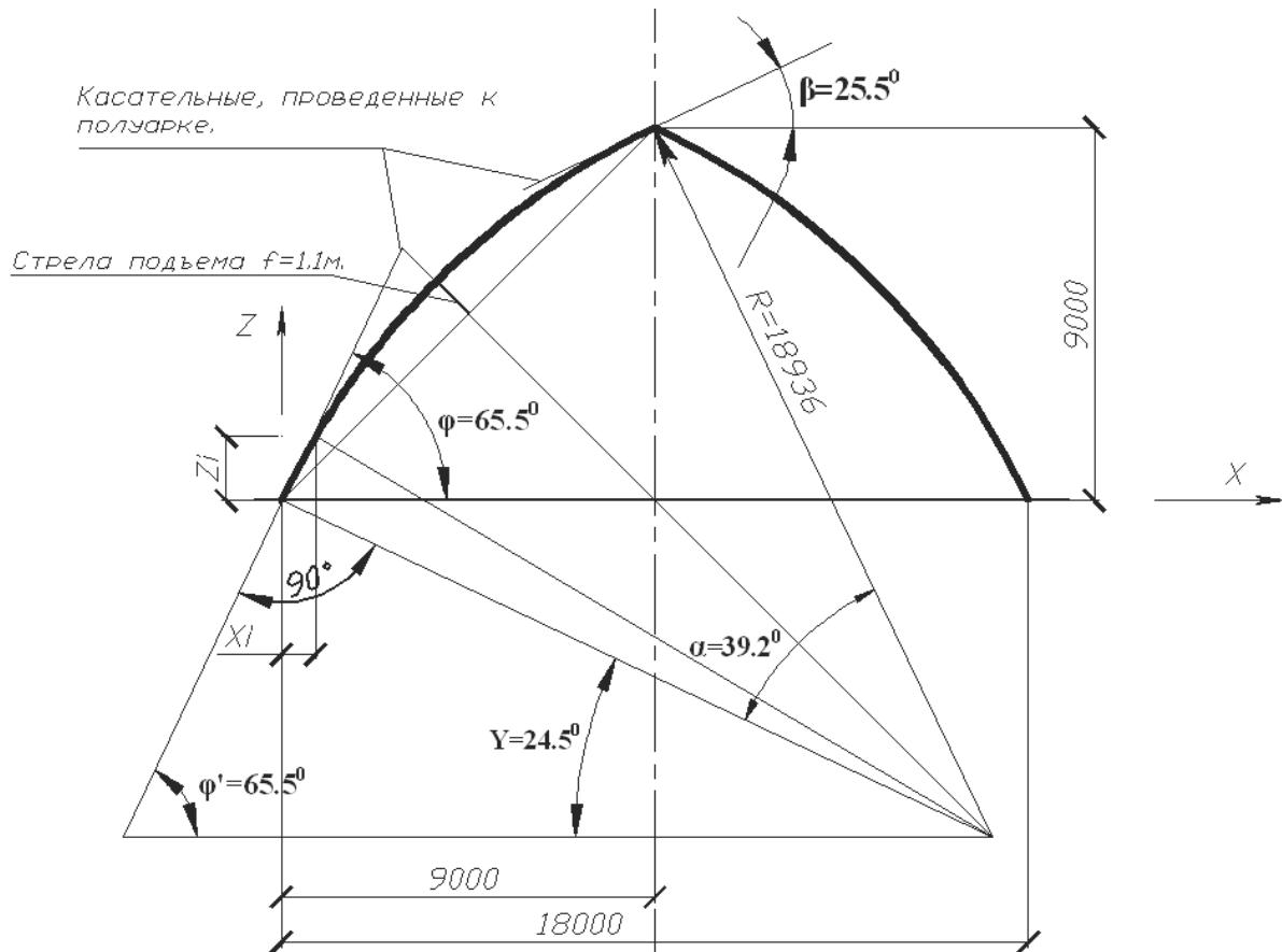
**Рисунок 46. Геометрические параметры арки**
