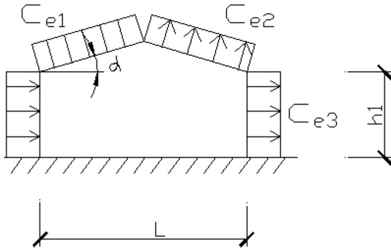
**Рисунок 35. Схема здания и ветровых нагрузок**
