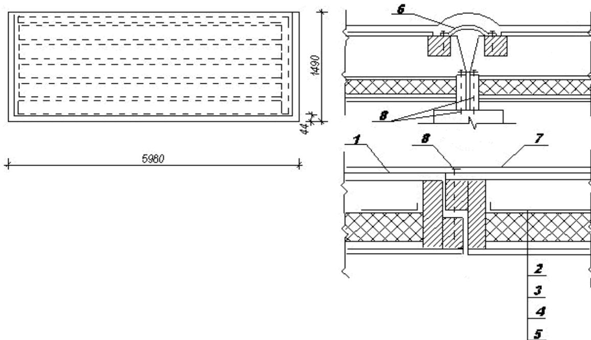
**Рисунок 8. Утепленная kleефанерная плита покрытия**
