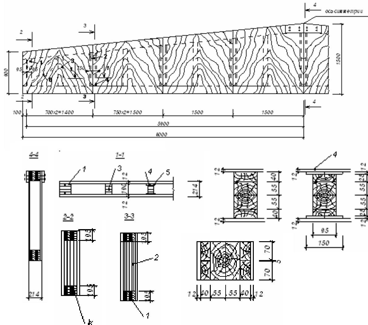
**Рисунок 16. Клееванная балка с плоской стенкой.**
