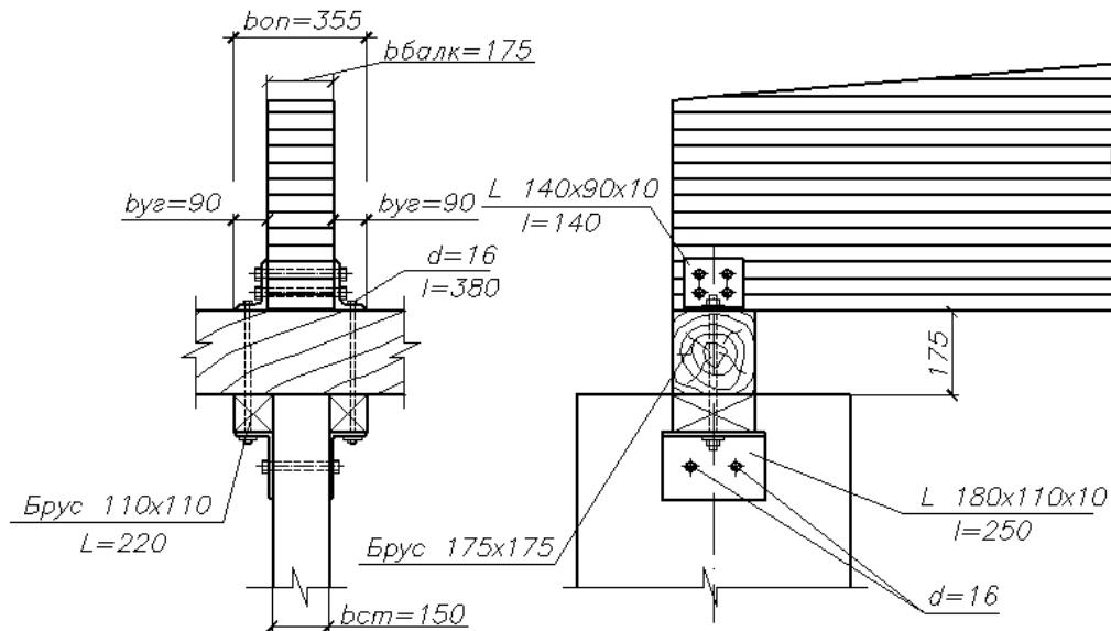
**Рисунок 77. Узел сопряжения балки со стойкой**
