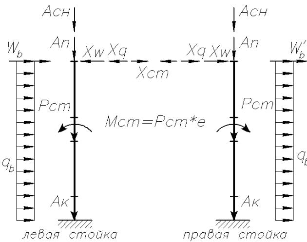
**Рисунок 72. Расчетная схема двухшарнирной рамы для определения усилий в стойке**
