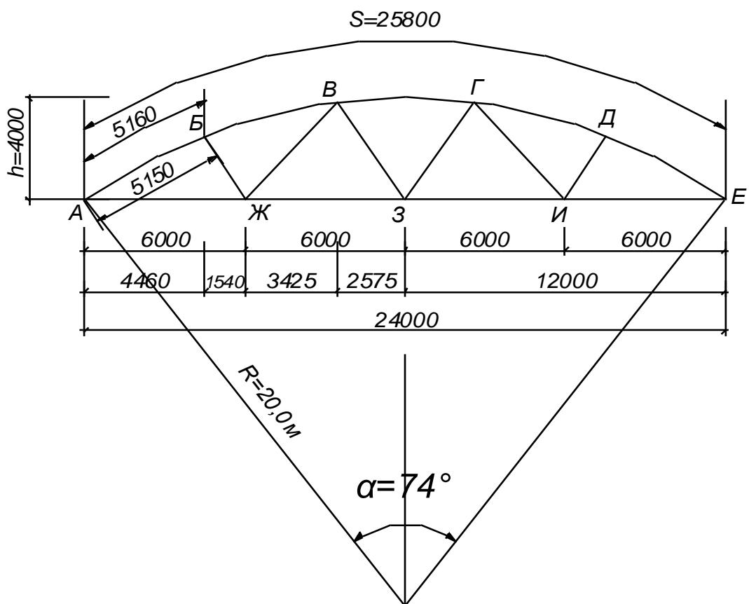
**Рисунок 26. Геометрические размеры фермы**
