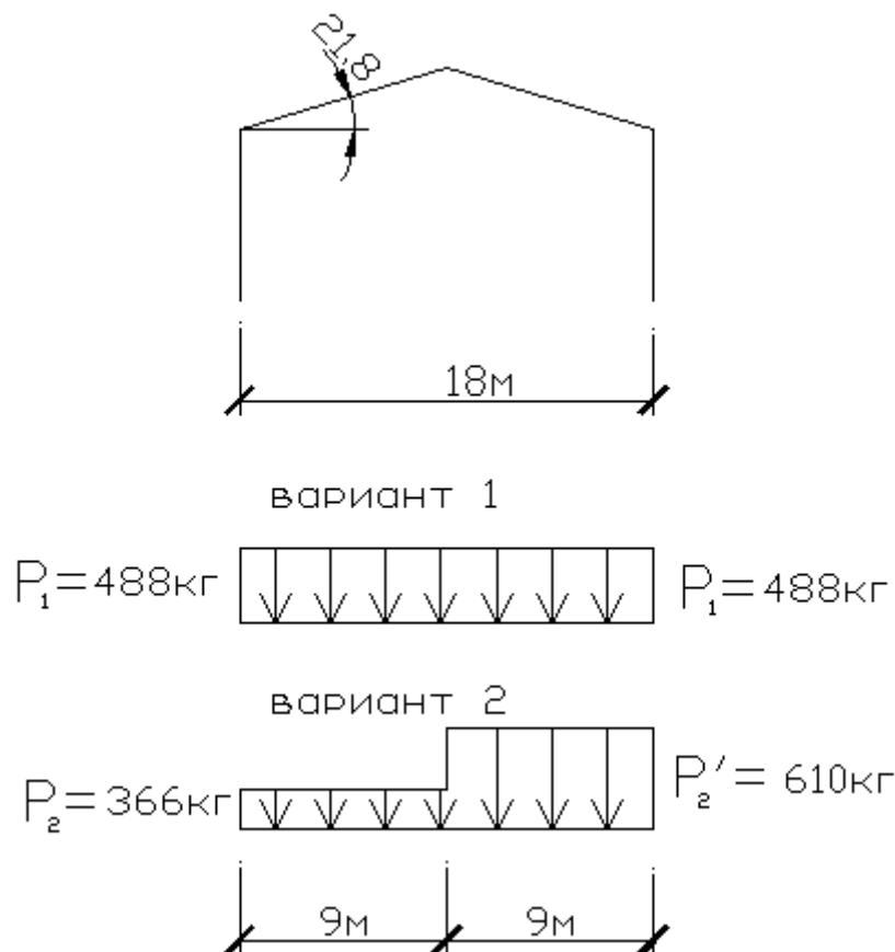
**Рисунок 34. Профиль покрытия и схемы снеговых нагрузок**
