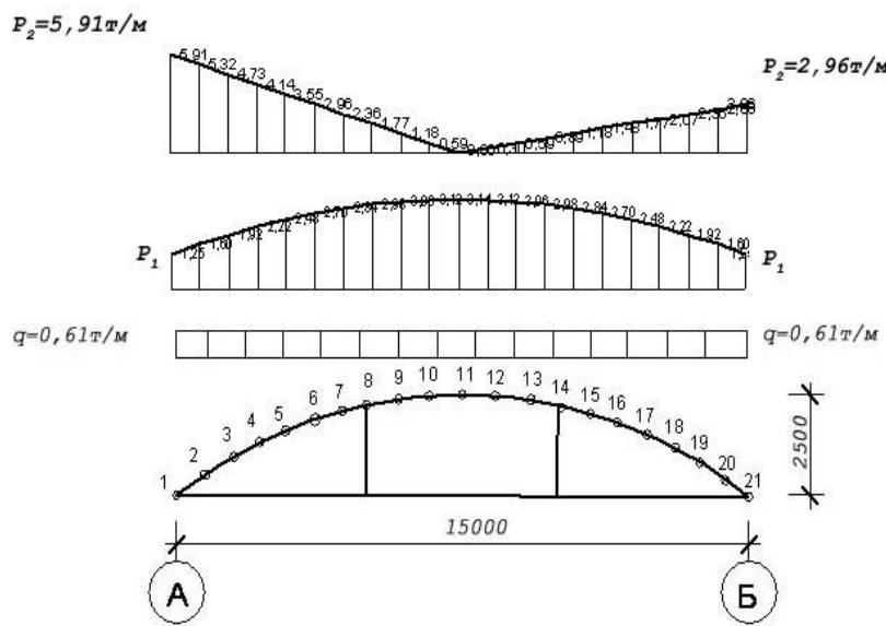
**Рисунок 51. Расчетная схема арки, нагрузки**
