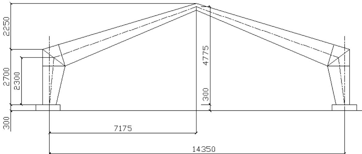
**Рисунок 61. Схема к определению ветровой нагрузки**
