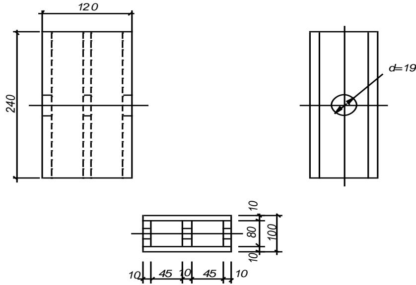
**Рисунок 32. Сварной вкладыш промежуточного узла верхнего пояса**
