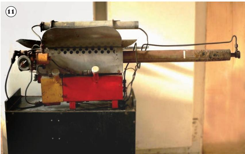
**10.** Генератор ЦАГ-ДЖЕТ-1 в работе. **11.** Ручной аэрозольный аппарат РАА-1
