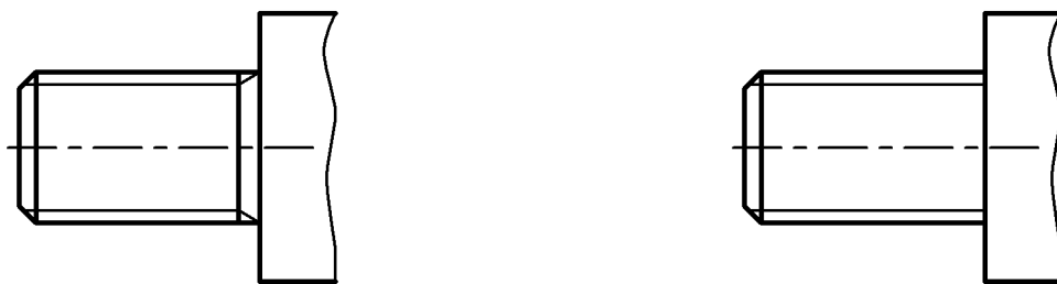
а) б) Рис. 1.7. Изображение резьбы, выполненной до упора: а — на чертежах деталей; б — на сборочных чертежах
