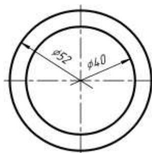
Рис. 15. Обрыв размерных линий при нанесении диаметра
