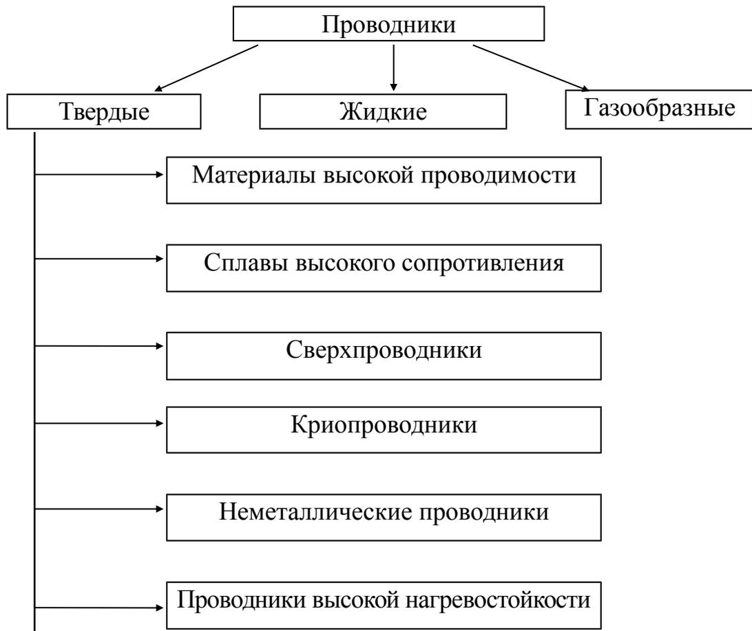
Рис. 4.1. Классификация проводниковых материалов
