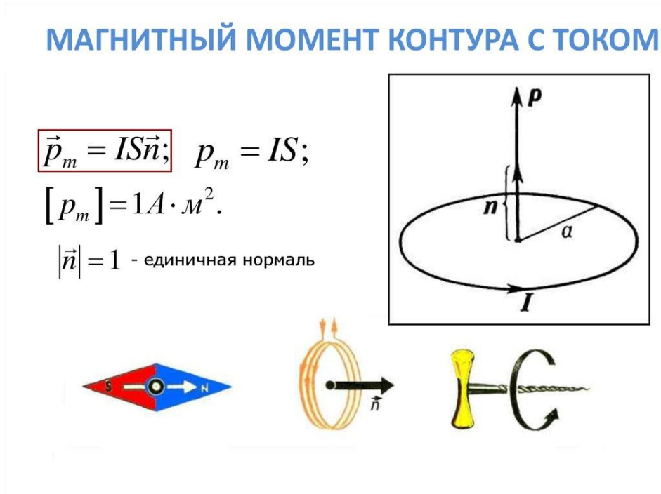
Рисунок 3. Формула для определения, единица измерения и направление вектора магнитного момента контура с током
