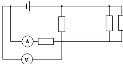
Q. Определите общее сопротивление нагрузки в электрической цепи (схема – справа), учитывая, что сопротивление вольтметра 200 Ом, сопротивлением амперметра можно пренебречь, а остальные сопротивления одинаковы и равны 8 Ом. Что покажет амперметр, если ЭДС будет равна 100 В?
