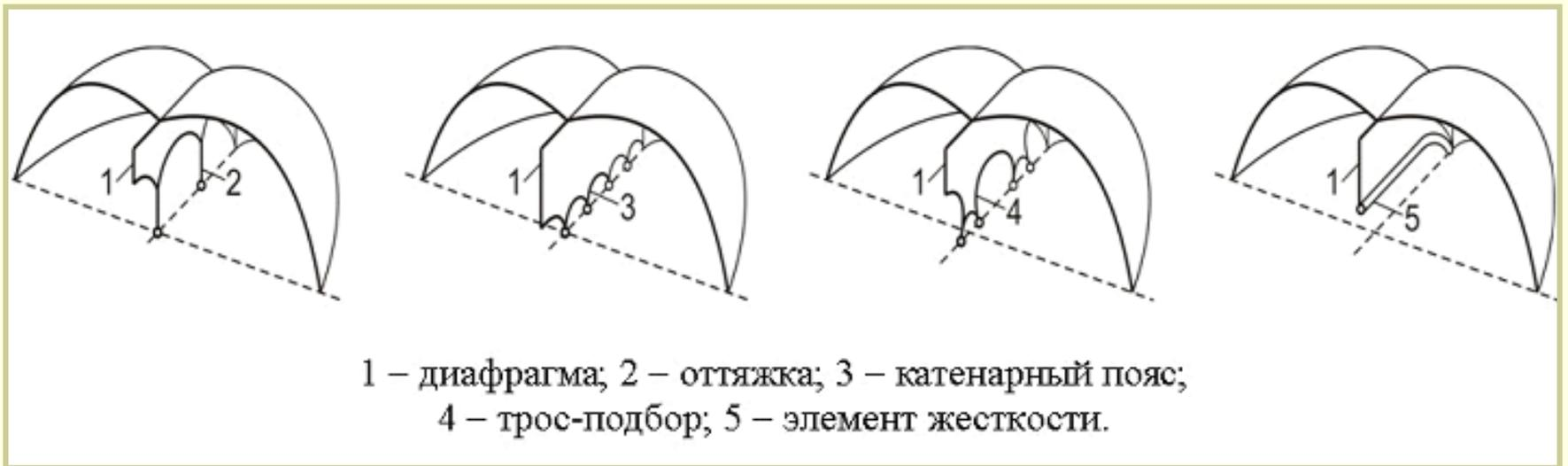
Мягкие диафрагмы позволяют изменить форму оболочки в соответствии с архитектурными требованиями, повысить жесткость на ветровую нагрузку.
