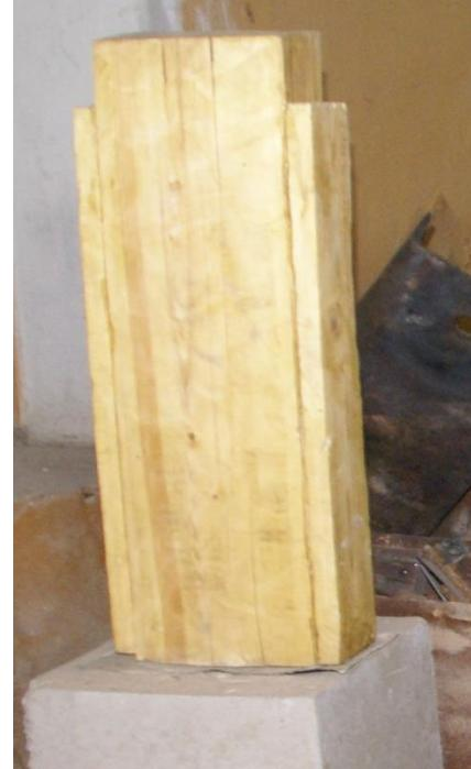
Зашемление колонны в фундаменте с помощью вклеенных стержней
