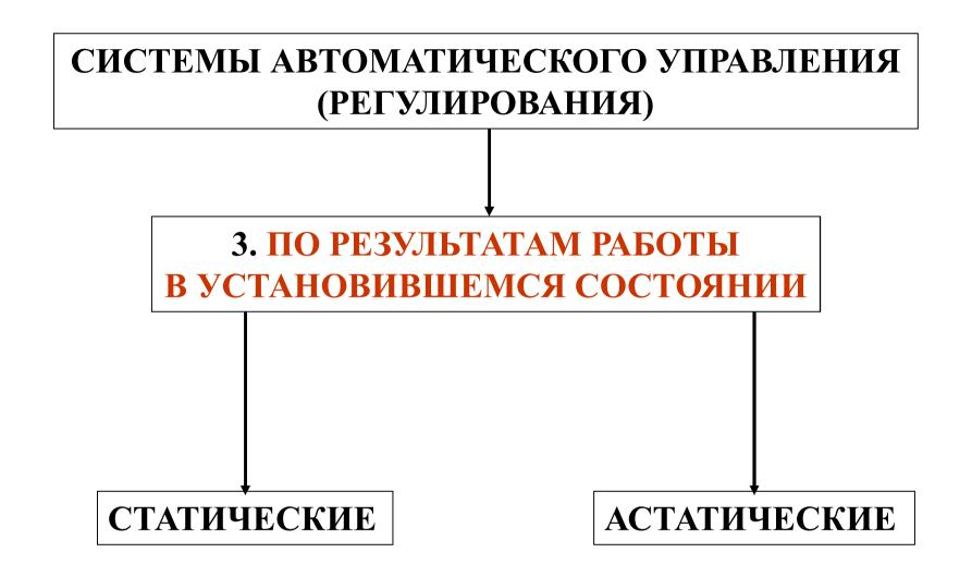
В астатических системах регулируемая величина по окончании переходного процесса, вызванного изменением задающего воздействия на величину ΔΥο (кривая 1) или компенсацией возмущающего воздействия (кривая 2) в точности равна заданному значению. Возможное отклонение (ошибка регулирования), свойственное реальным системам, обусловлено несовершенством ее элементов, например зоной нечувствительности УУ.
