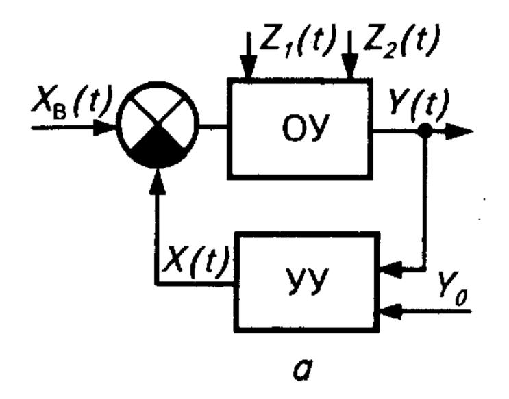
Признак замкнутой системы, действующей на отклонение регулируемой величины, — обратная связь с выхода ОУ на его вход, элементом которой является управляющее (регулирующее) устройство УУ.
