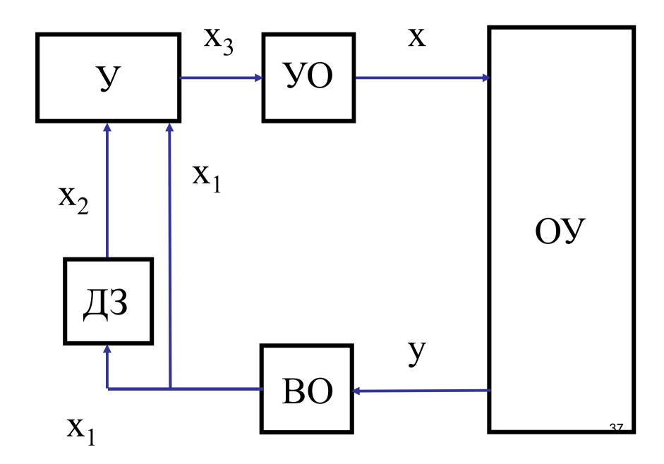
Производную в закон регулирования можно ввести, включив дифференцирующее звено ДЗ между воспринимающим органом ВО и усилителем У. Определим закон регулирования такой системы.
