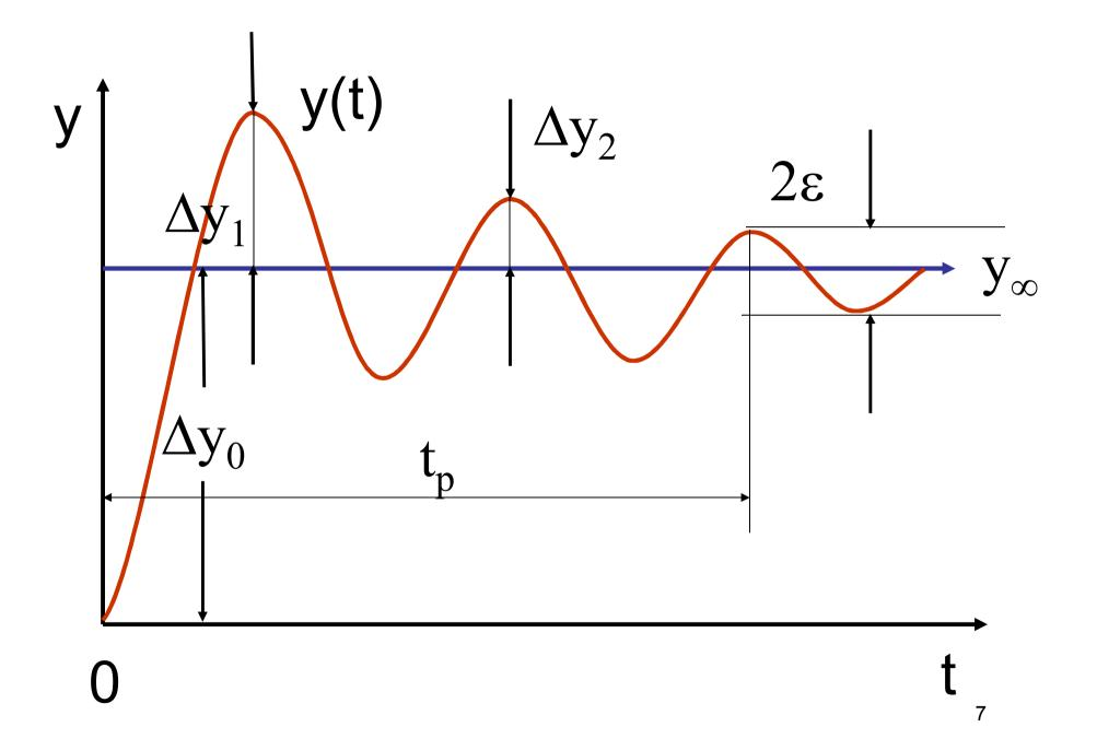
Величина перерегулирования характеризует количественно динамическую ошибку и определяется коэффициентом перерегулирования
