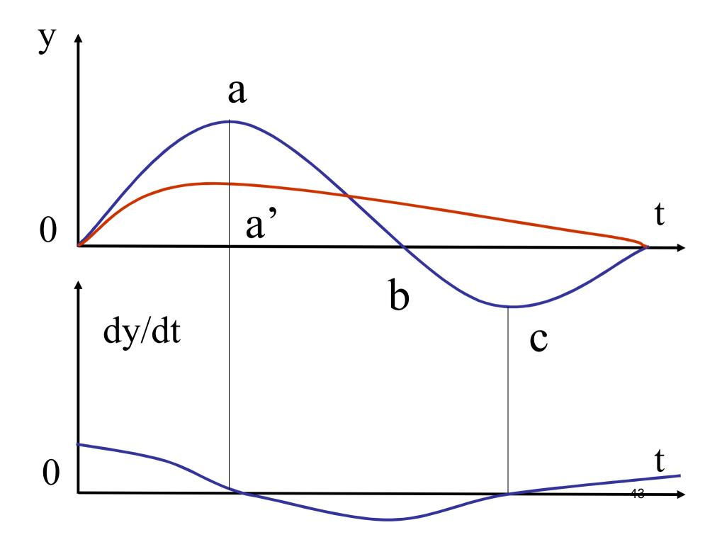
Если регулятор пропорционального регулирования  $y=k_{p}x$ , то до тех пор пока y>0, регулятор воздействует на объект управления в направлении, уменьшающем положительное отклонение. Регулятор будет действовать в обратном направлении, когда изменится знак отклонения: у<0.
