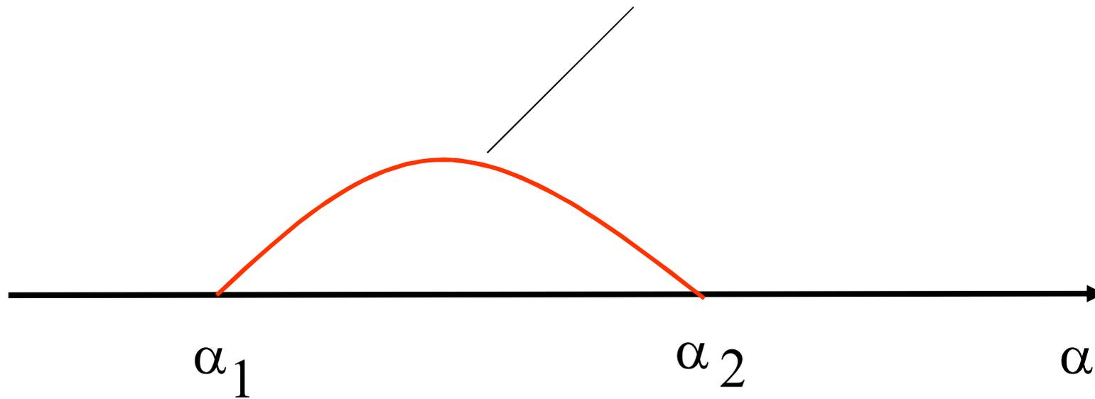
Для подбора параметров линейных САР пользуются так называемым методом D-разбиения плоскости комплексных переменных, вещественная часть которых равна исследуемому параметру. Этот метод позволяет найти устойчивые и неустойчивые области изменения исследуемого параметра в зоне частот от  $-\infty$  до  $+\infty$
