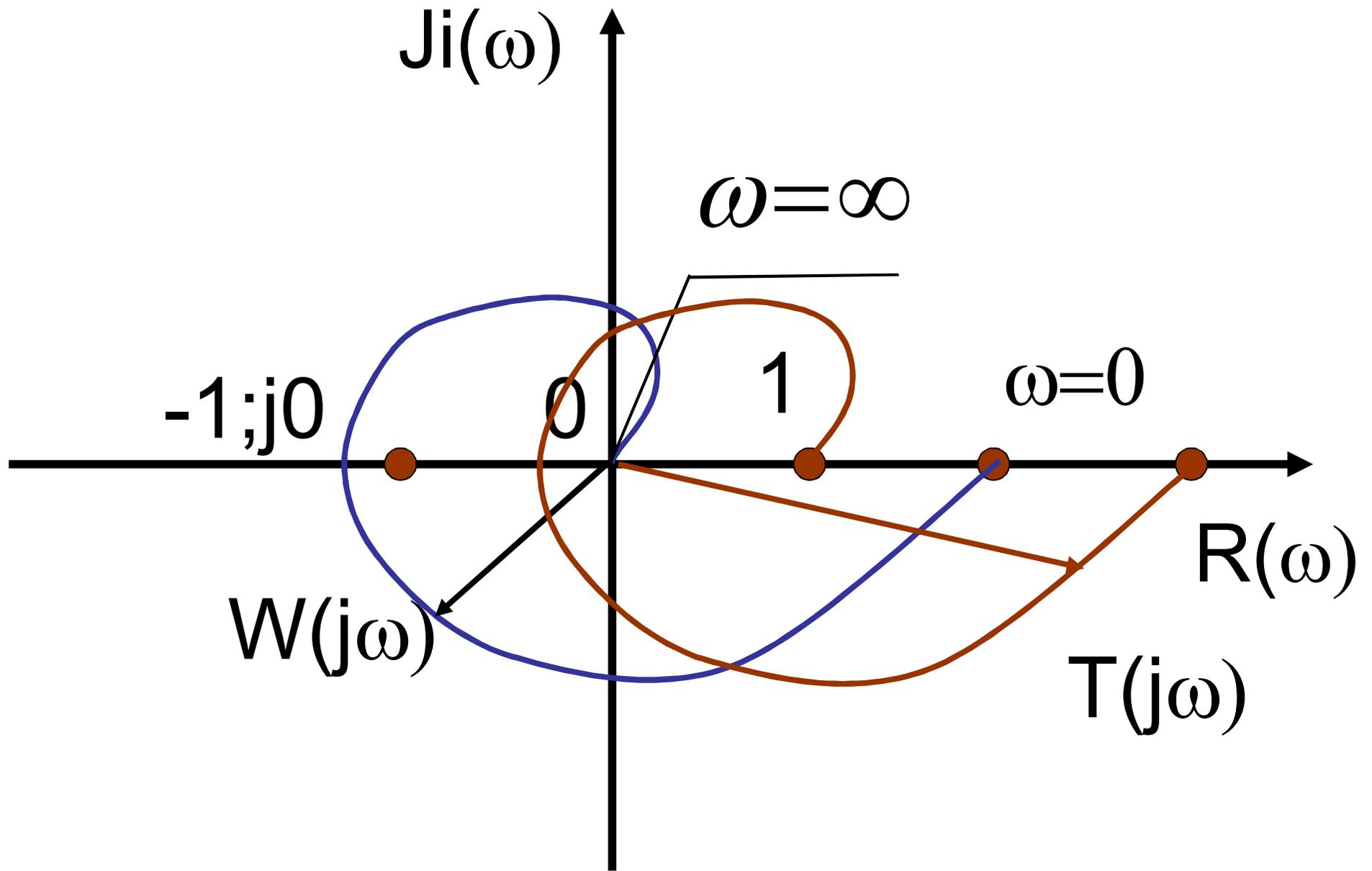
*Система автоматического регулирования, неустойчивая в разомкнутом состоянии, будет устойчива в замкнутом состоянии, если ее амплитудно-фазовая характеристика в разомкнутом состоянии при изменении частоты  $\omega$  от 0 до  $\infty$  охватывает точку с координатами  $-1; j0$  в положительном (против часовой стрелки) направлении  $q$  раз.*
