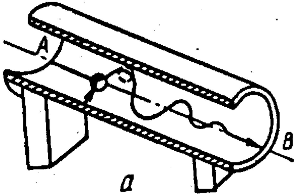
При любом отклонении шарика от установившегося направления движения он после нескольких колебаний возвращается на первоначальную прямую  $AB$ . Если шарик совершает движение по желобу, то при малых отклонениях шарика, не выходящих за края желоба, его движение будет устойчивым, а при больших отклонениях— неустойчивым
