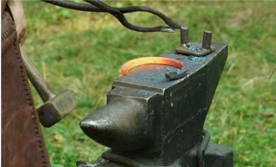
Ручная ковка используется в кузнечных мастерских при изготовлении небольшого количества изделий
