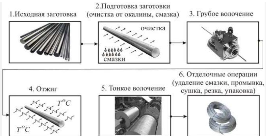
Технологические процессы получения проволоки методом волочения
