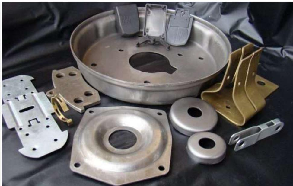
Примеры изделий, изготовленных методом листовой штамповки
