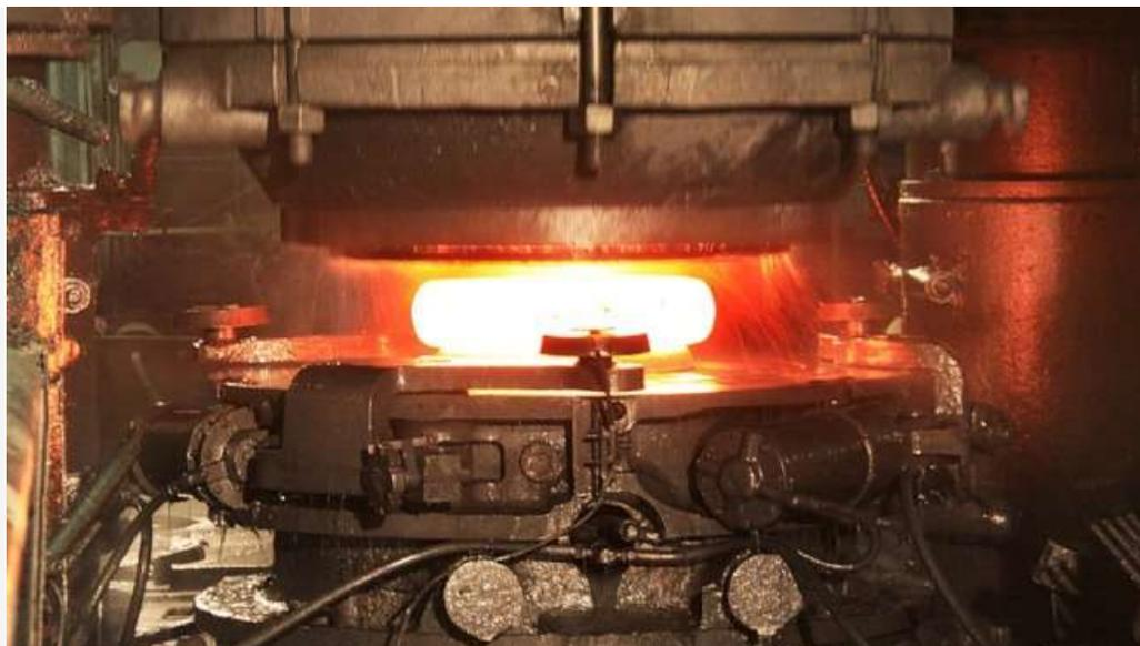
Ковка раскаленной заготовки на молоте – вид горячей обработки металла давлением
