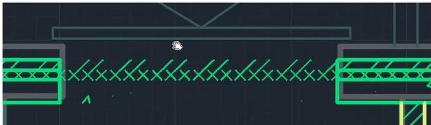
Штриховку, как назначают, так и удаляют внутри замкнутого контура. Поэтому вводим замкнутый контур в виде построения прямоугольника
