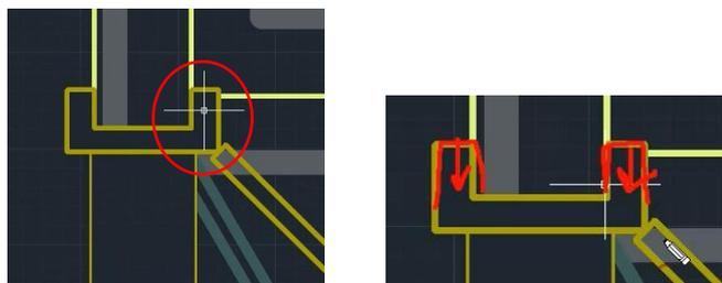
Для корректировки выделяем этот дверной блок Редактирование-Расчлнить
