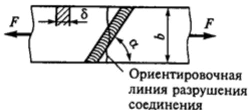
Рис. 18.1. Косой стыковой шов
