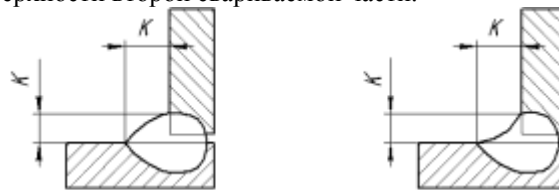
Рис. 13.2. Катет углового шва: а – выпуклого; б – вогнутого
