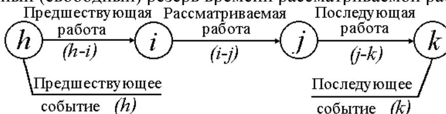
Рис. 5. Нанесение расчетных параметров сетевых моделей на график.
