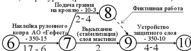
Рис. 4. Обозначение зависимостей (фиктивных работ) на сетевом графике «В-С»
