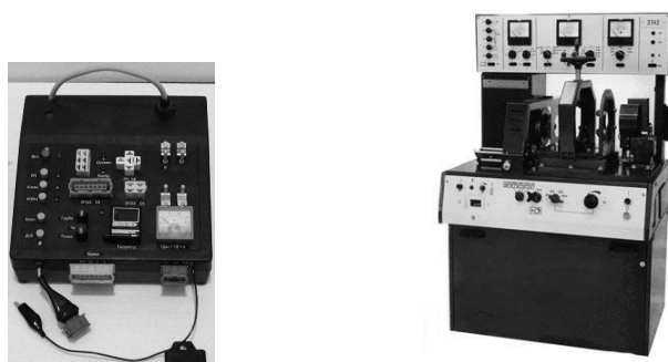
Рис. 81. Прибор и стенд для проверки автомобильного электрооборудования
