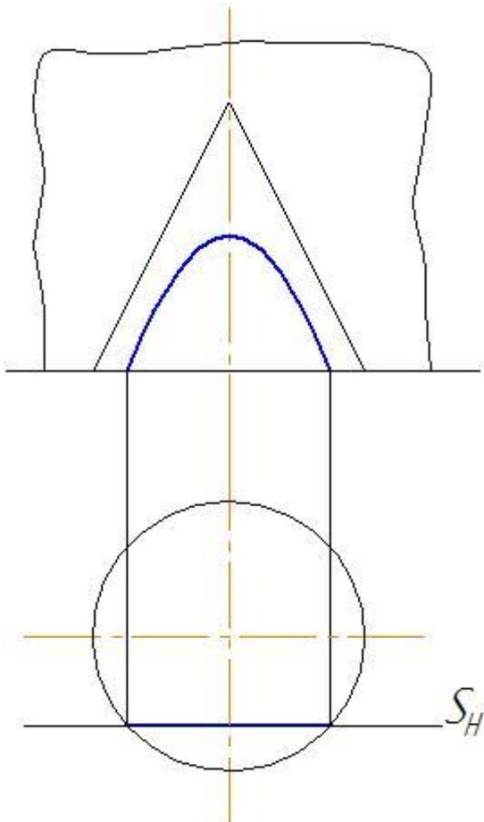
Если секущая плоскость  $\parallel$  одной образующей кругового конуса, то в сечении конуса получается парабола.
