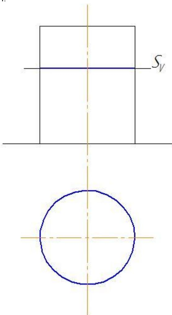
Если секущая плоскость перпендикулярна оси вращения прямого кругового цилиндра, то в сечении получается окружность.
