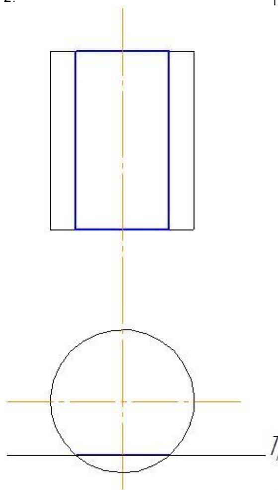
Если секущая плоскость параллельна оси вращения прямого кругового цилиндра, то в сечении получается прямоугольник
