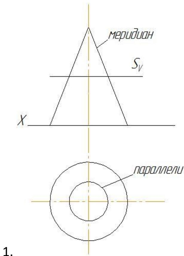
Если секущая — В перпендикулярна оси вращения, то в сечении прямого кругового конуса получаются окружности разного диаметра.
