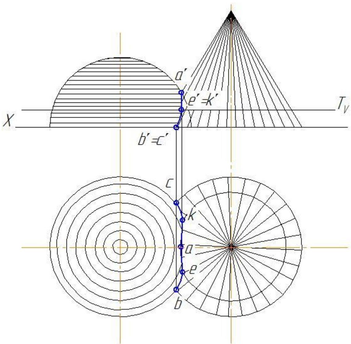
Рассмотрим две пересекающиеся поверхности вращения, оси которых параллельны.
