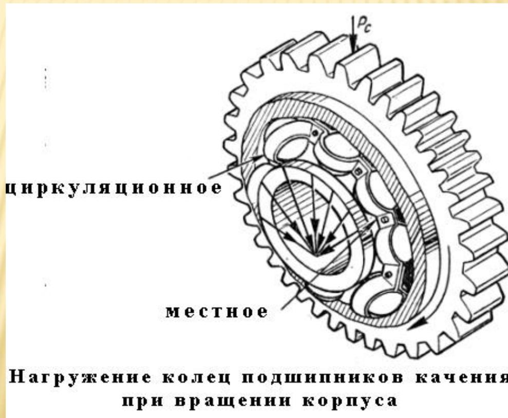
При циркуляционном нагружении кольцо воспринимает нагрузку последовательно всей окружностью, что наблюдается при вращении кольца вместе с сопрягаемой деталью при постоянном направлении нагрузки. При этом монтаж подшипника на вал или в отверстие корпуса осуществляют по посадке с натягом, чтобы исключить проворачивание кольца относительно сопрягаемой детали под действием нагрузки.
