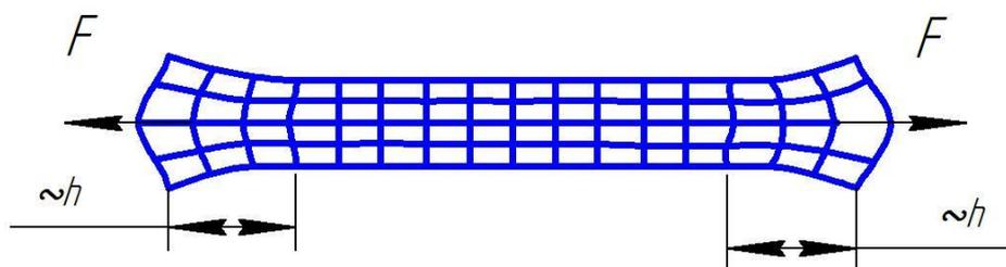
Сечения стержня, примыкающие к месту приложения силы искривляются больше, чем ближе они расположены к силе  $F$ . Такая неравномерная картина деформирования стержня имеет место в ограниченной области, обычно на расстоянии, примерно равной наибольшему
