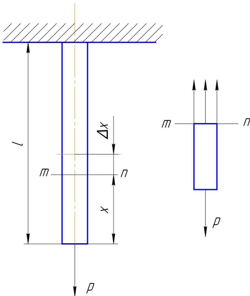
К нижнему концу детали приложены растягивающая сила  $P$ . Силы, действующие на верхнем конце, представляют собой действие частиц верхней части деформированного стержня. Эти силы равномерно распределены по поперечному сечению. Наиболее близким по характеру распределения является давление пара. При чем в данном случае наибольшее
