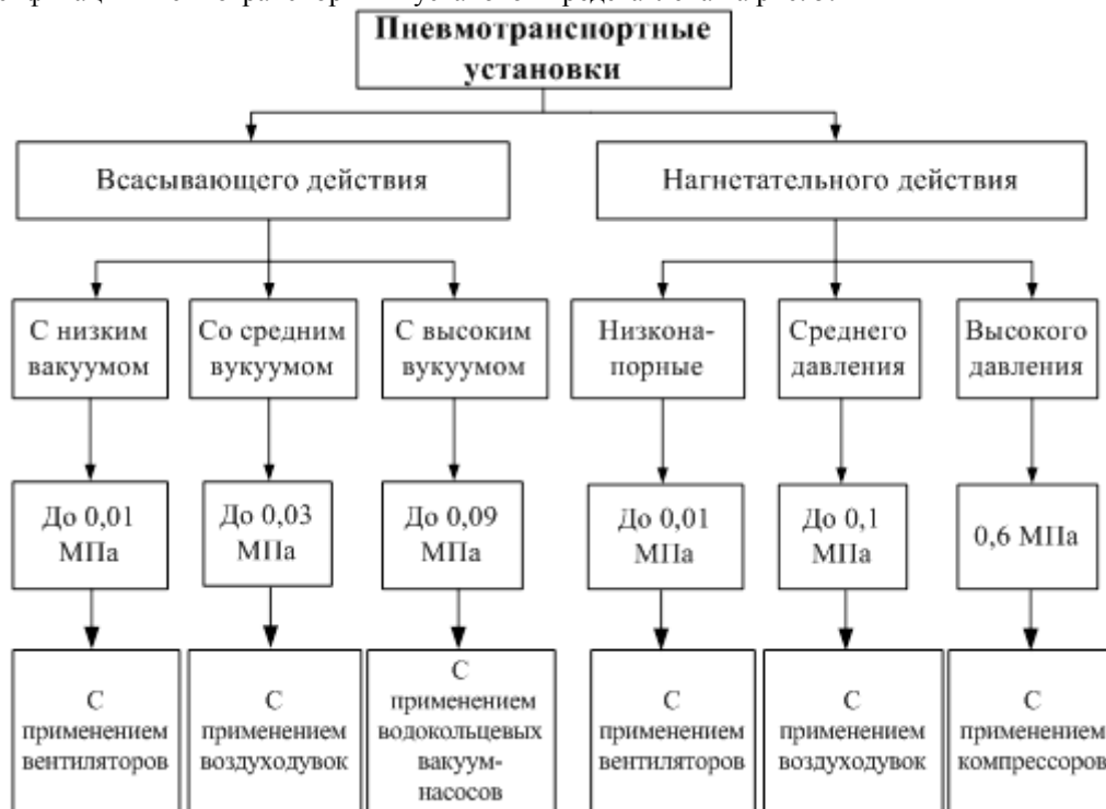
Рис. 5. Классификация пневмотранспортных установок.
