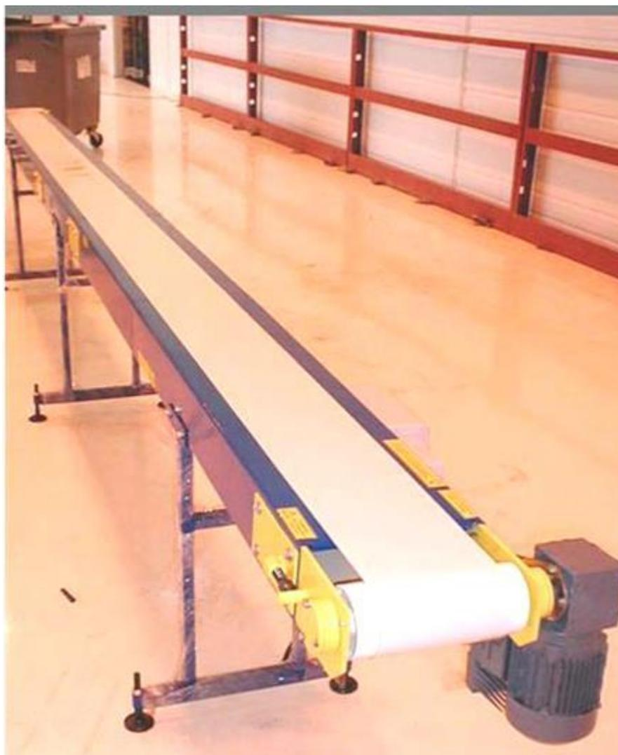
Рис. 52. Переносной ленточный конвейер для легких штучных грузов со сплошным поддерживающим настилом
