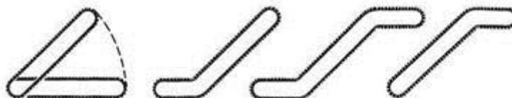
Рис. 50. Схемы трасс Z-образных конвейеров
