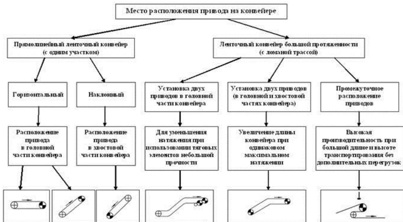
Рис. 17. Схема к определению места расположения привода ленточного конвейера
