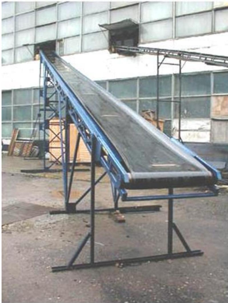
Рис. 53. Ленточный наклонный конвейер для штучных грузов
